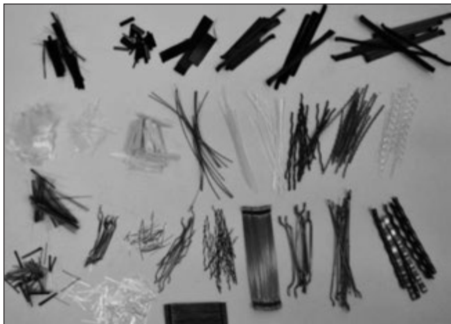
1. ábra: Betonhoz alkalmazható néhány jellegzetes szál
