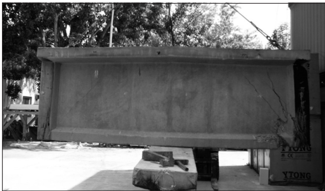
13. ábra: A Mix 3-ból készült gerenda a tönkremenetel után
