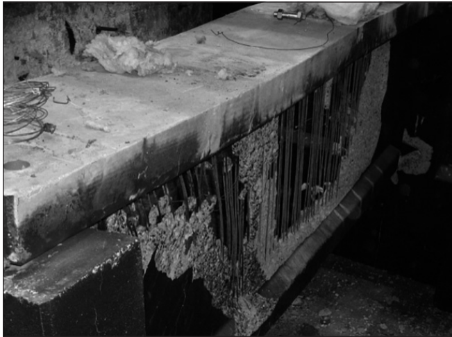
12. ábra: A referencia keverékből készült gerenda a tönkremenetel után (Mix 0)
