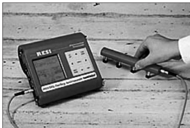
3. ábra: A RESI típusú, Wenner elrendezésű ellenállásmérő
