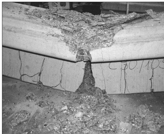
2. ábra: A C90/105 jelű betonból készült kísérleti FPT gerenda hajlítási tönkremenetele
