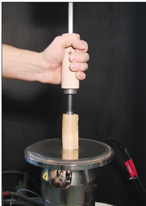
4. ábra. A kézi ütési vizsgálatok elrendezése
