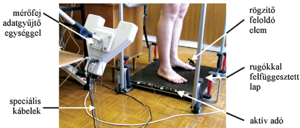
1. ábra. Az ultrahangalapú, hirtelen irányváltoztatási teszt elrendezése
