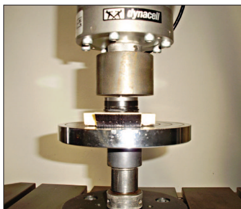
6. ábra. A mérőcella dinamikus tesztelése szervo-hidraulikus vizsgálógéppel
