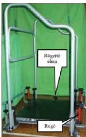
1. ábra. PosturoMed® a különböző irányokban azonos merevségű rugókkal a merev kerethez kapcsolt merev lap, a rögzítőelemmel a lap elmozdulásmentesen rögzíthető a kerethez
