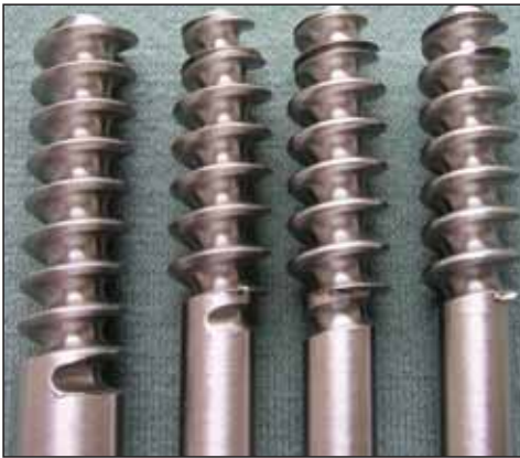
3. ábra. A megváltoztatott menetprofilú csavarok (bal oldalon a simplex csavar)
