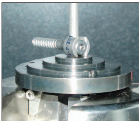
13. ábra. Gerincimplantátum és a rúd kapcsolatának stabilitásvizsgálata
