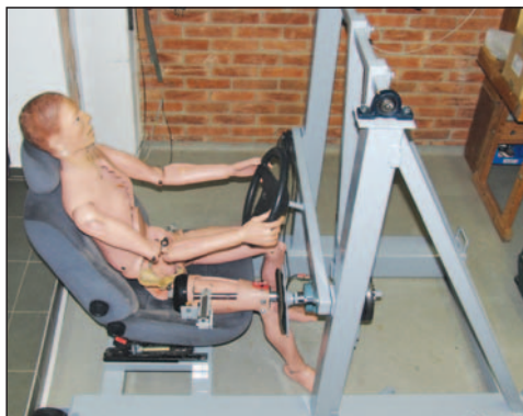
10. ábra. A csípőprotézis sérüléseit modellező rendszer
