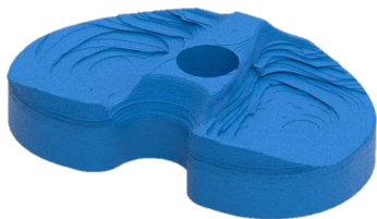
7. ábra. A létrehozott paraméterezhető virtuális modell eredeti és simított felületekkel
