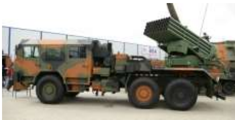
8. kép: Poland-Nexter lehetséges alváza, a képen sorozatvető csőköteggel
