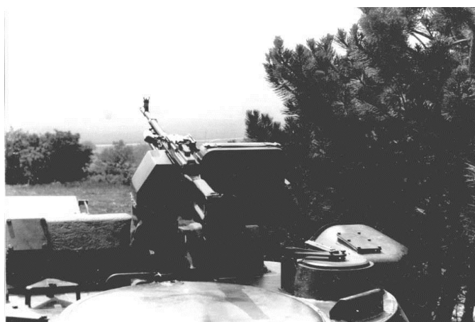
2. sz. kép: 1V14 harcjármű a kombinált parancsnoki figyelőműszerrel képes éjszakai körülmények között is a célfelderítésre és a tűzmegfigyelésre
