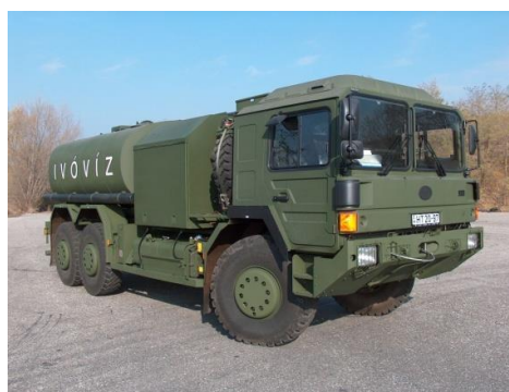
6. sz. kép 8000 literes ivóvíz-szállító terepjáró tehergépkocsi 12
