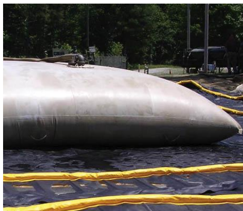
7. sz. kép Ivóvíztároló tartály (hasonló kialakítású tartályok akár 1.000.000 literes tárolókapacitással is beszerezhetőek) 14
