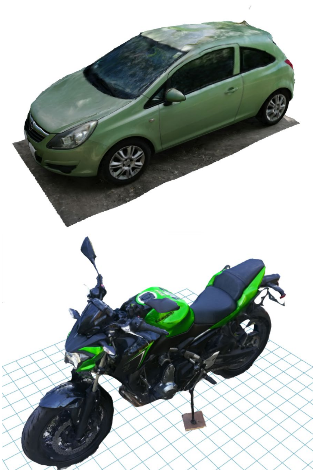
10. ábra: a személygépkocsiról és a motorkerékpárról generált modellek
