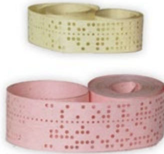
1. ábra: ötcsatornás (fent) és nyolccsatornás (lent) lyukszalag
