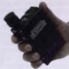
6. KÉP A SEMTECH CÉG SMP1000-ES RADARIRÁNYÁSV-ADÓJA MINDÖSSZE CIGARETTASDOBOZ MÉRETŰ
