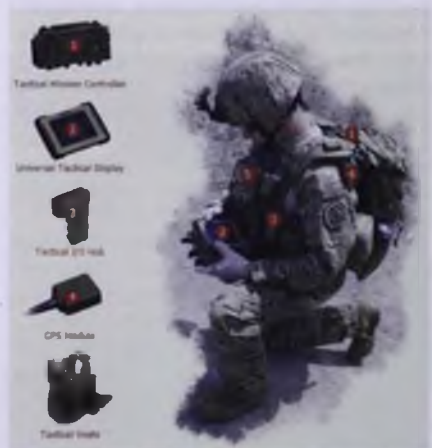
11. KÉP A MODULAR TACTICAL SYSTEM EGYMAGBAN TARTALMAZZA A REPESZÁLLÓ MELLÉNYRE SZERELT RÁDIÓT, A GLOBÁLIS HELYMEGHATÁROZÓT, A VIDEOJEL VÉTELÉRE ALKALMAS BERENDEZÉST ÉS A SZÜKSÉGES KIJELZŐT
