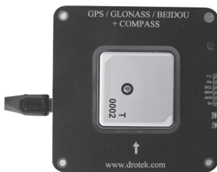
2. ábra U-blox M8N navigációs vevő fejlesztői készletbe ágyazva (A szerző fotója)
