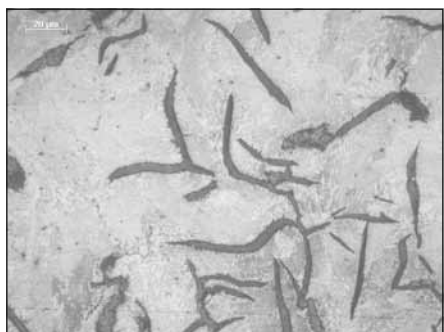
7. ábra. Az agyúgolyó mikroszerkezete nagyobb nagyításban
