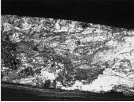
11. ábra. A repesz töretfelülete 8x-os nagyításban a külső felülethez közel
