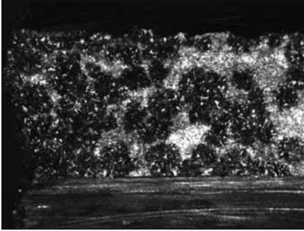
12. ábra. A repesz töretfelülete 8x-os nagyításban a belső felülethez közel
