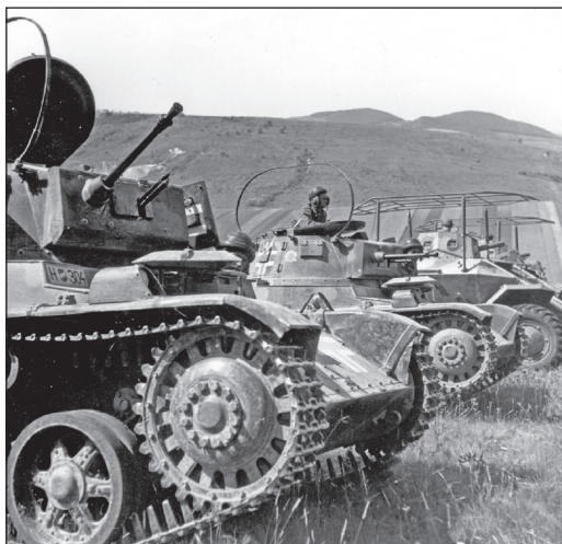
1934/37A M géppuska 1938 M Toldi harcokcsi toronyba beépítve
