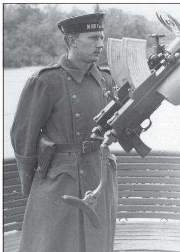
1934A M géppuska felhasználása légvédelmi fegyverként 79
