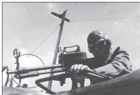
Forgógyűrűre sarkcsappal szerelt megfigyelő géppuska
