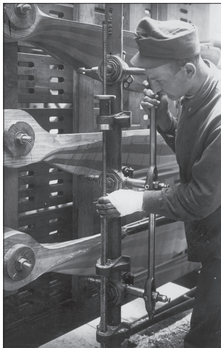
28. kép: Légszavak sorozatgyártása korabeli marógéppel
