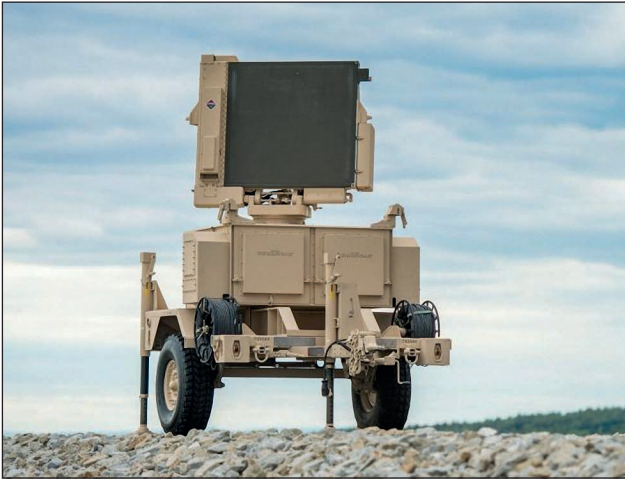
4. ábra. Az AN/MPQ-64F1 Sentinel utánfutóra szerelt változata [7]
