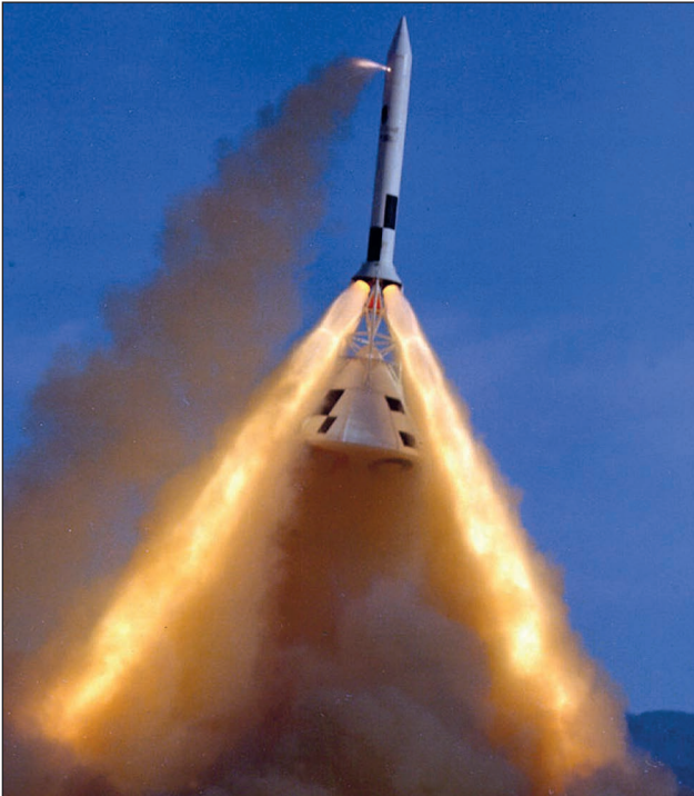
2. ábra. A mentőrakéta tesztelésénél is boilerplate űrkabint használtak (Fotó: NASA)
