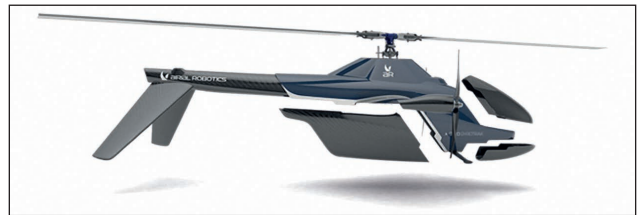
59. ábra. A Gyrotrak GT20 moduláris törzskialakítása [28]
