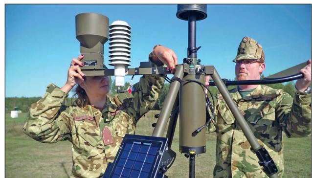
12. ábra. Harcászati meteorológiai állomás (TacMet) összeszerelése (Forrás: MH GEOSZ)
