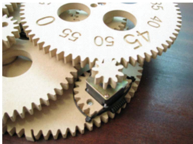
13. ábra. Ciklois fogprofilú fogaskerék-kapcsolat.
