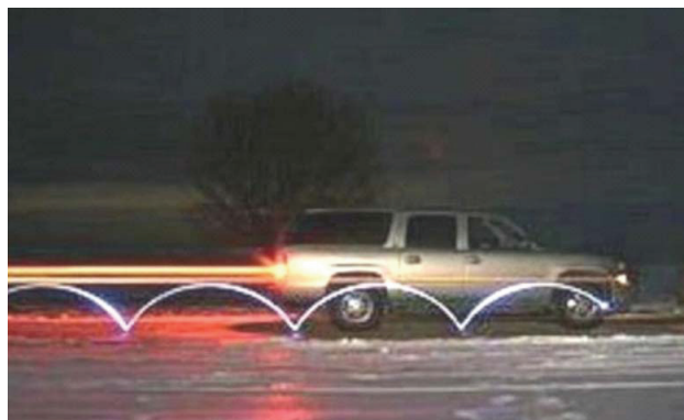
1. ábra. Járműkerék külső pontjának pályája.
