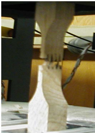
2. ábra – A rostirányú húzószilárdság vizsgálata
