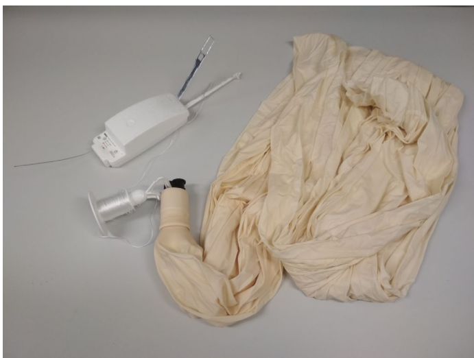
2. ábra: RS41-SGP rádiószonda TOTEX 600 grammos léggömbbel, szeleppel és orsóval összekötve, közvetlenül a betöltés előtt
