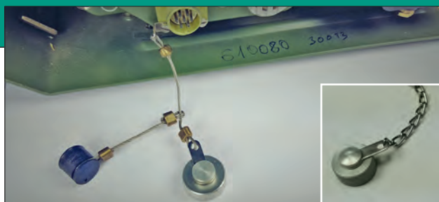
5. ábra. A tesztelés során az eszköz számítógépes csatlakozójának porvédő sapkája leszakadt, attól kezdve a gyártó cég lánc helyett acélsodronnyal rögzíti a műszerek porvédő sapkait. Az ábrán az RDC III AG készülék számítógépes csatlakozójának porvédője láncos rögzítéssel a jobb oldalon, illetve acélsodronnyos rögzítéssel a bal oldalon
