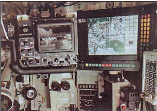
11. ábra. A Leopard 2 korszerű tűzvezető rendszerének vezérlőtere
