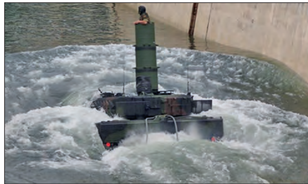
16. ábra. Egy Leopard 2-es harckocsi víz alatti átkelése. A torony búvónyílására szerelt búvócsövön keresztül jut levegőhöz a kezelőszemélyzet, valamint a motor
