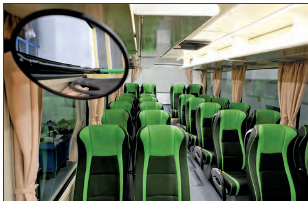
17. ábra. A személyszállító modulban FOURCE Aktív típusú fokozatmentesen állítható ülések, klíma-befúvó, LED-lámpa, kapcsolható hangszóró, kísérvívó, USB-foglalat teszi kellemesebbé az utazást
