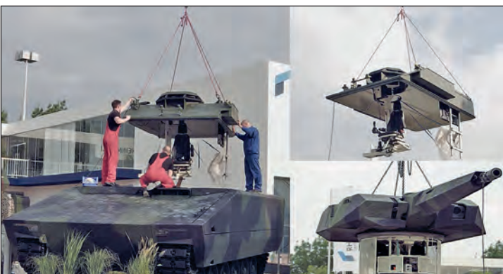
7. ábra. A Lynx KF41 harcjármű moduláris kialakításának demonstrációja a 2018-as Eurosatory kiállításon
