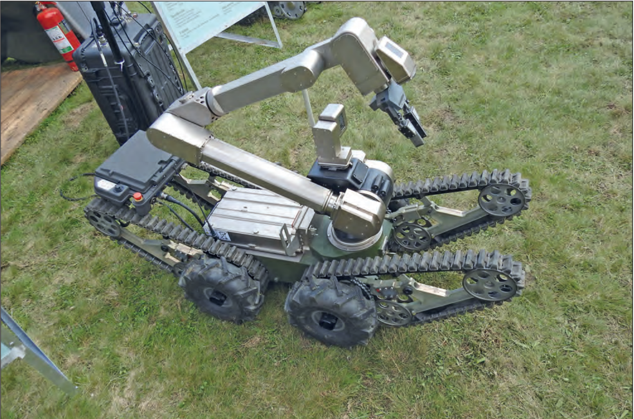
4. ábra. A tűzszerezőrobot kerek futóművét lánctalpas futóművel egészítették ki a kedvezőbb lépcsőmászó-képesség elérése érdekében [10]
