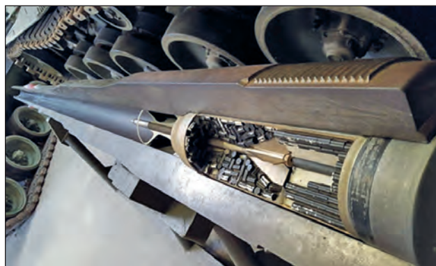
9. ábra. A Leopard 2-es fő fegyverének, a Rheinmetall 120 mm-es sima csövű ágyúnak metszete. Benne egy betöltött, űrméret alatti páncéltörő lőszer, amelyben jól látható a nyíllövedék
