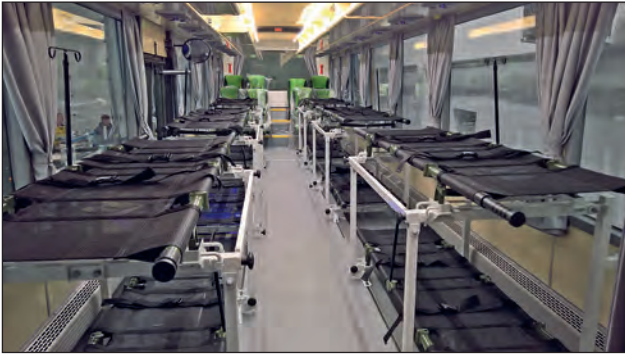
18. ábra. A jármű 12 hordágyon fekvő sérültet szállíthat. A sérültek közúti szállítására rendkívül szigorú feltételek vonatkoznak, amelyeknek a CURRUS ARIES 01 sebesültszállító változata tökéletesen megfelel
