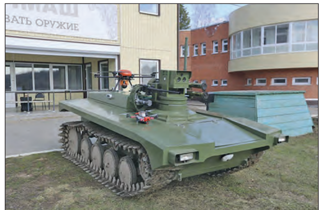
3. ábra. A felderítő helikopter-UAV az alkalmazott UGV felépítményéről indul, és valós idejű információkkal segíti annak terepi mozgását, illetve harcát [26]
