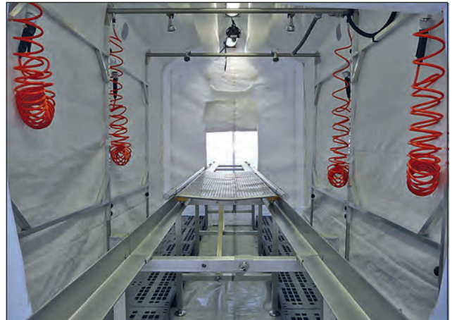
19. ábra. Az SMR sátor középső sorának berendezése kétféle (sebesült-/személyi) mentesítési alkalmazásnál
