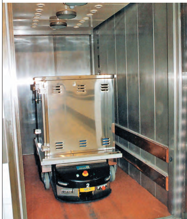
2. ábra. A logisztikai robot élelmiszert, ruházati anyagot és orvosi felszerelést szállít a Magyar Honvédség Egészségügyi Központban
