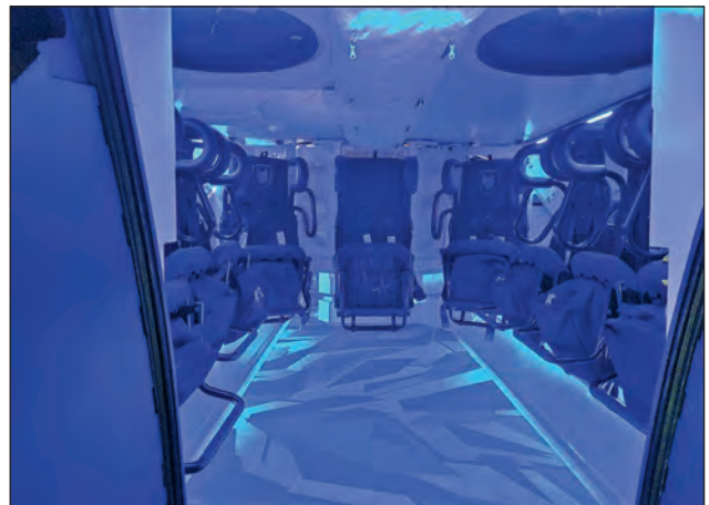
9. ábra. A KF41 harcjármű küzdőtere 9 db Schroth SU-63 típusú üléssel
