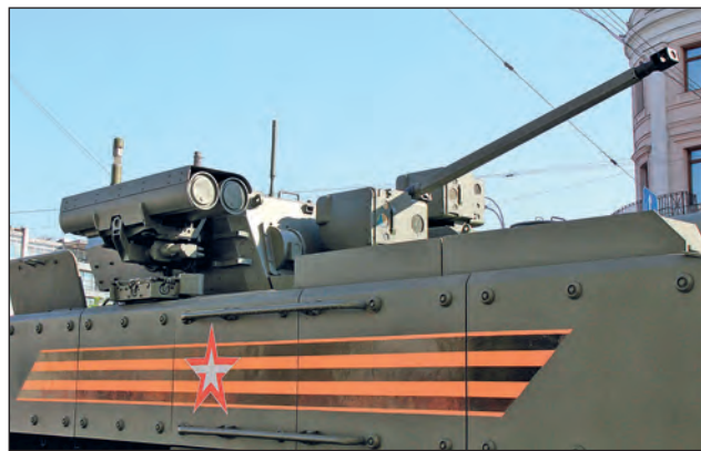
97. ábra. A VPK-7829 K-17 kerekos gyalogsági harcjármű Bumerang-BM tornya, középen a 30 mm-es 2A42 gépágyúval, oldalán a Kornet-EM páncéltörő rakétákkal
