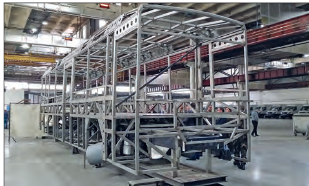
15. ábra. Így születik az autóbusz: a kocsiszekrény acélrács-szerkezetére lassan felkerülnek, az alumínium oldallemezek
