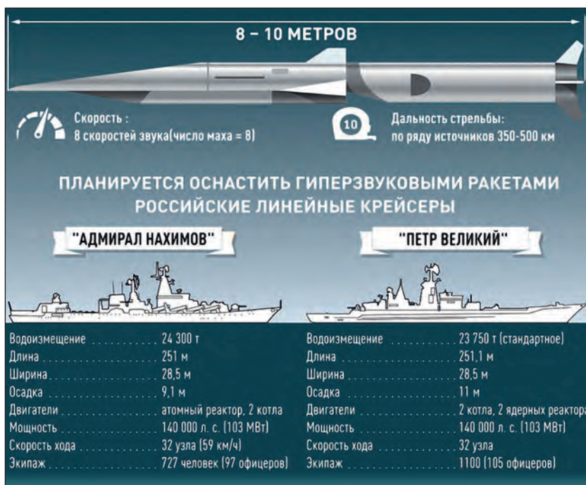
39. ábra. 3M22 Cirkon hiperszonikus rakéta. Hossza 8-10 m, sebessége 8 Mach, lőtávolsága 350-500 km. Jelenleg a következő rakétacirkálókra tervezik a felszerelésüket: ADMIRAL NAHIMOV, PJOTR VELIKIJ. Az ADMIRAL NAHIMOV jellemzői: vízkiszorítás 24 300 t, hosszúsága 251 m, szélessége 28,5 m, hajótervezet 9,1 m. Meghajtás: atomreaktor, a 2 kazán teljesítménye 103 MW (140 000 LE), menetsebesség 32 kn (59 km/h). Legénysége 727 fő (97 tisz). A PJOTR VELIKIJ jellemzői: vízkiszorítás 23 750 t, hosszúsága 251,1 m, szélessége 28,5 m, hajótervezet 11 m. Meghajtás: 2 nukleáris reaktor, a 2 kazán teljesítménye 140 000 MW (103 LE), 32 kn (59 km/h). Legénysége 1100 fő (105 tisz)
