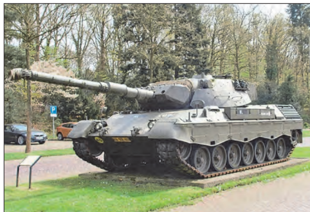
3. ábra. A 36 t tömegű Leopard 1A5V típusú harckocsi döntött torony- és homlokpáncézzal, 105 mm-es löveggel Amersfoortban, a Holland Páncélos Múzeumban
