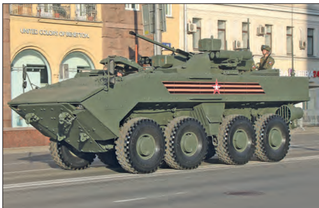
95. ábra. VPK-7829 K-17 Bumerang kerekos gyalogsági harcjármű. A motor és az áttételi művek a vezetőtől jobbra találhatók. A képen látszik a gépágyúfegyverzettel párhuzamosított 7,62 mm-es 6P7K PKTM géppuska, és a két célzóberendezés (bal oldali nézet)
