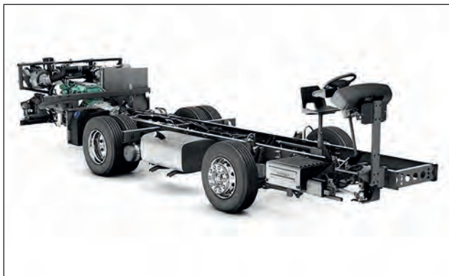
13. ábra. A Volvo B8R önjáró alváz készre szerelve érkezik a székesfehérvári üzembe, ahol a megfelelő hosszúságú rácsközéprésszel meghosszabbított alvázra kerül a kocsiszekrény. A Volvo önjáró alváz – a kiváló motornak és hajtásláncnak köszönhetően – ideális választás volt
