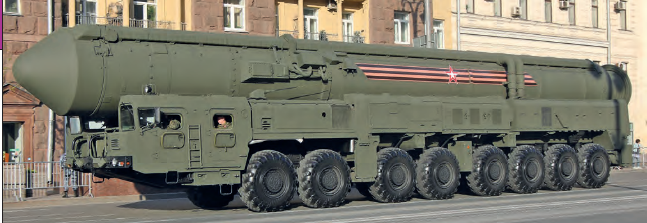
91. ábra. Az RSz-24 Jarsz hadászati rakétakomplexum 15U175M hordozó- és indítójárműve a 15ZS55M hadászati interkontinentális ballisztikus nukleáris rakétával, bal oldali nézet
