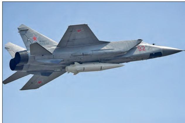
44. ábra. MiG–31 elfogó vadászgép Kinzsal rakétával felszerelve. A Kinzsal az Iszkander rakéta átalakított, repülőre szerelhető változata. A rakéta lőtávolsága 2000 km
