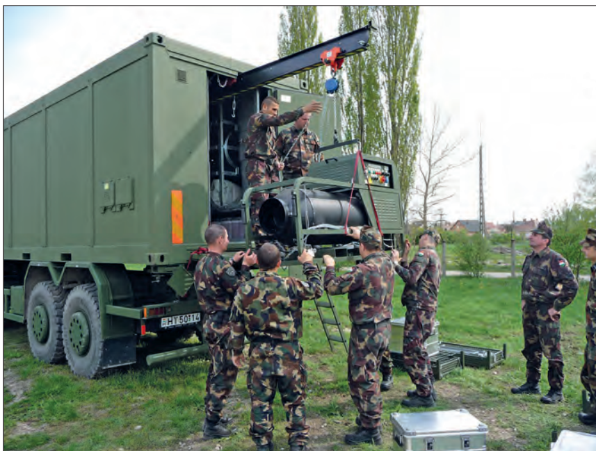
12. ábra. Mentésítőanyag szállító konténer (MASZK) a kiegészítő felszerelések telepítése közben
