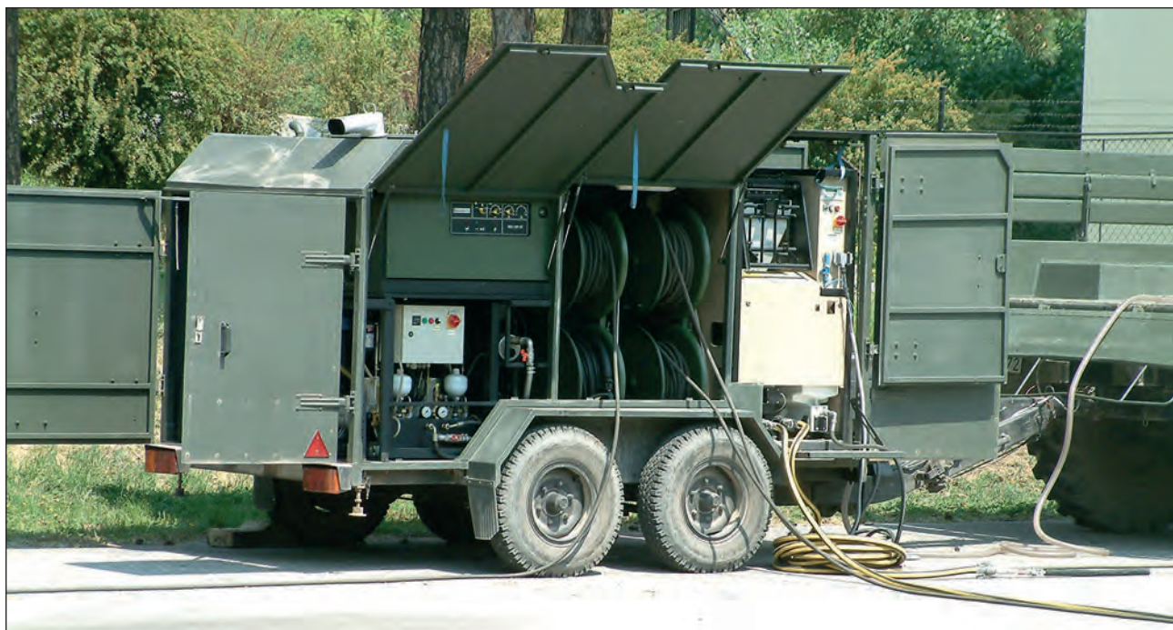
7. ábra. Zászlóalj mentesítő utánfutó (ZMU) első generációjá MPDS főkezelő modulal
