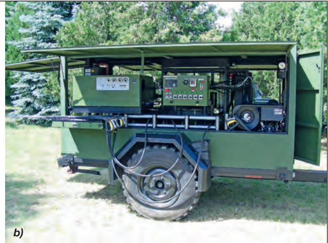
9. ábra. Második generációs ZMB (a), és az AMGDS főkezelő moduldal rendelkező utánfutója ZMU (b)
