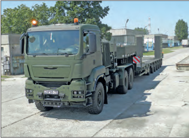
2. ábra. MAN TGS 40.540 6x6 BBS-MIL típusú nyerges vontató Goldhofer STZ-H 6 (245) M típusú nehézgépszállító félpótkocsival (Fotó: Baranyai László)
