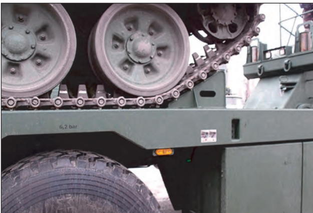
13. ábra. Rögzítőék elhelyezése a lánctalp előtt
