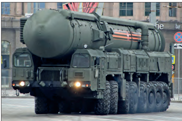
92. ábra. A 15U175M nyolctengelyes MZKT-79221 járműve kanyarodás közben. Működés közben látható az első és a hátsó három kormányzott futómű
