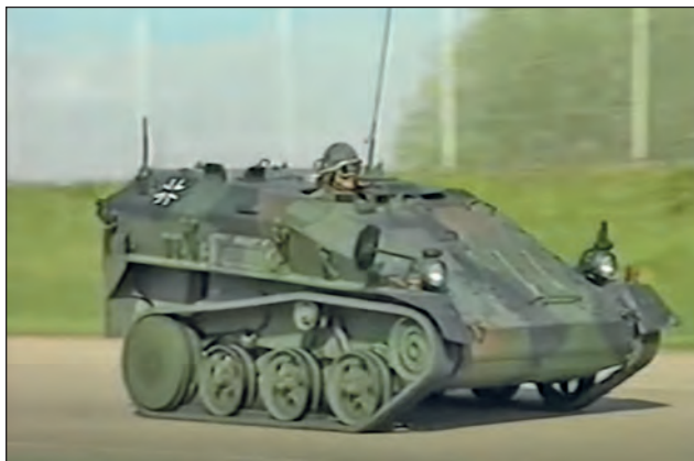
28. ábra. Dízel-elektromos hajtásláncú Wiesel 1 LLX a teszt pályán
