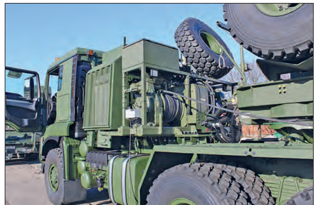
4. ábra. A nagyméretű hűtőradiátor és a TGS Sepson csőrő bal oldali, leeresztett csőrőlőkötéllel
