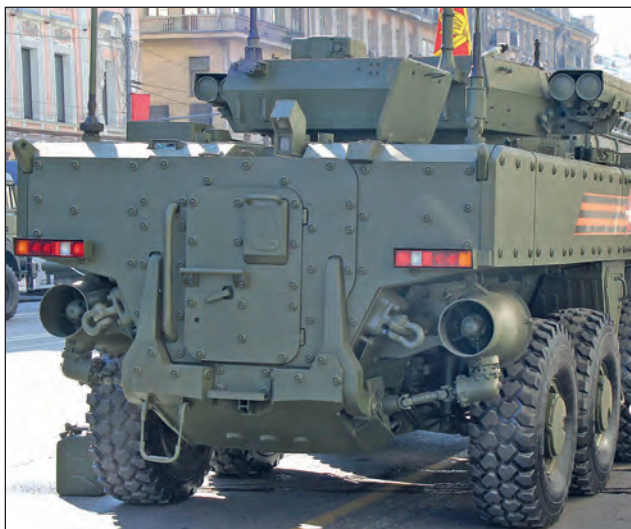
96. ábra. VPK-7829 K-17 Bumerang kerekos gyalogsági harcjármű hátulról. A képen megfigyelhető a hátsó ajtó, az ajtó feletti kamerás megfigyelőrendszer, valamint a kétoldali vízsugar-hajtómű
