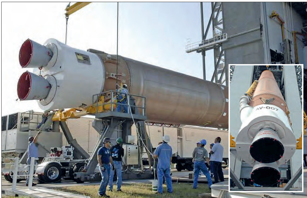
2. ábra. A kétfűvókás RD-180 hajtómű az Atlas V első fokozatában. Az AV-007 példány a 401-es számjelet viselte, tehát nem volt gyorsító fokozata (Fotó: NASA)
