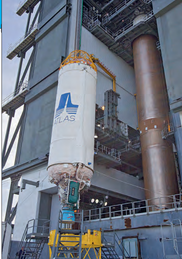
4. ábra. A Centaur fokozatot ráemelik az Atlas V első fokozatára (Fotó: NASA)
