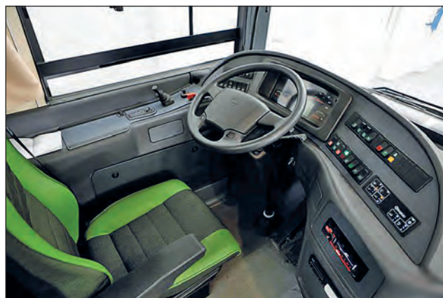
14. ábra. A CURRUS ARIES 01 vezetőállása. A műszerfalon elhelyezett nyomógombok a nyílászárók, az I-Shift és más berendezések vezérlését szolgálják
