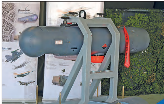
16. ábra. A magyar Gripenekhez is rendszeresített Litening célfelderítő és -megjelölő konténer a precíziós csapásmérés elengedhetetlen eszköze. A rendszeresített GBU-12 (Paveway II) lézervezérlésű bombákat is a célmegjelölő konténer segítségével juttatják célba
