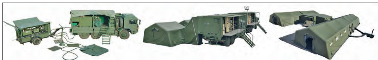
8. ábra. A Magyar Honvédség korszerű (második generációs) mentesítő berendezései, a képen balról jobbra: zászlóalj mentesítő berendezés (ZMB + ZMU), konténeres mentesítő berendezések (KMB), személyi mentesítő konténer (SZMK)
