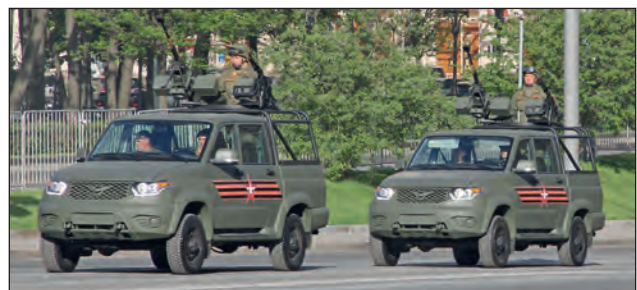
90. ábra. Az UAZ-3163 Patriot pickup könnyű személyszállító gépjárművek bukócsőveire fegyverzetként 12,7 mm-es 6P57 Kord nehéz géppuskát és a 7,62 mm-es 6P41 PKP géppuskát szereltek fel
