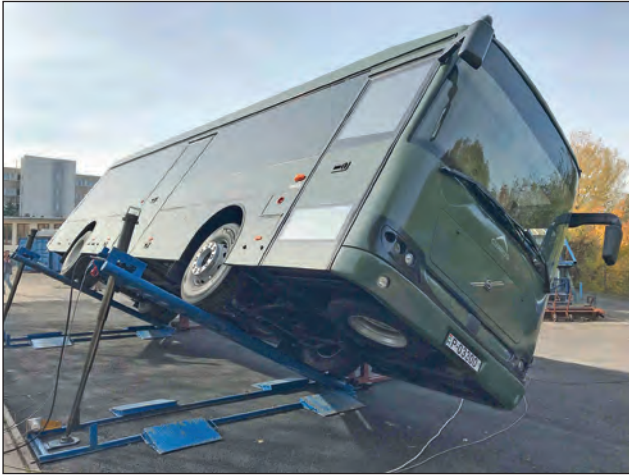
11. ábra. A CURRUS ARIES 01-nek is teljesítenie kell az ENSZ EGB biztonsági előírásait. A képen a jármű kritikus borulási szögét mérik be. Az értékek minden moduláris elrendezéssel, a megengedett értékben belül kell maradnia
