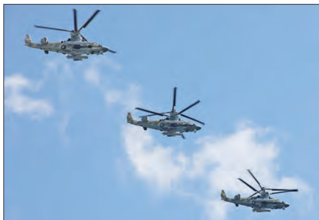
103. ábra. Ka-52 kettős koaxiális forgószárnyú harcihelikopter-kötelék. A helikopterek két külső üzemanyagtartállyal repülnek
