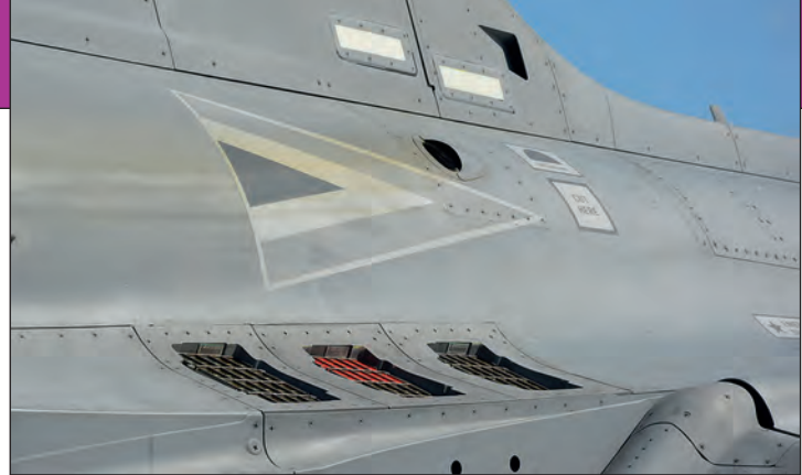
17. ábra. Az aktív ellentévekenység eszközei hosszas integráció során váltak teljessé a JAS-39-eseken. Egy harc feladat végrehajtása során ma is elengedhetetlen eszközök az infracsapda és dipólszóró berendezések. A képen a Magyar Honvédség egyik Gripenjének infracsapda és dipólszóró kazettái, a repülőgép törzsének végébe építve
