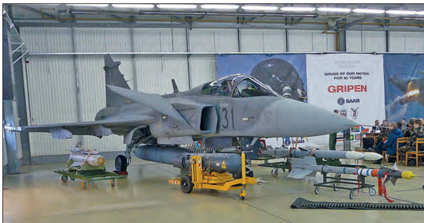
12. ábra. Magyar Gripen vadászpilótógép a kecskeméti repülőbázison. Az alkalmi rendezvényen kiállított repülőgép körül a JAS-39C változathoz az MH által rendszeresített harceszközök közül az AIM-9L Sidewinder és az AIM-120C-5 AMRAAM légi harc-rakéták gyakorló változata, az AGM-65 Maverick földi célok elleni rakéta gyakorló változata, 27 mm-es gépágyúlőszerkek és egy Litening IIIE célmegjelölő konténer látható
