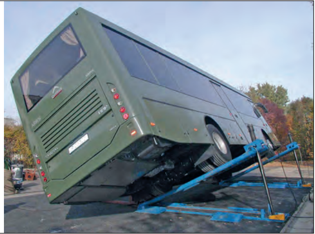
11. ábra. A CURRUS ARIES 01-nek is teljesítenie kell az ENSZ EGB biztonsági előírásait. A képen a jármű kritikus borulási szögét mérik be. Az értékek minden moduláris elrendezéssel, a megengedett értékben belül kell maradnia
