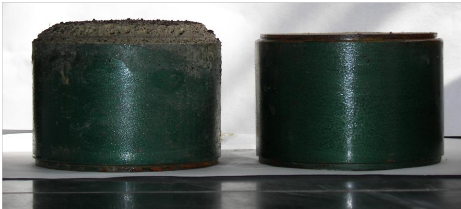
11. ábra: „Adony” talaj áztatás után, bal oldalon kezeletlen, jobb oldalon 4% mésszel kezelt minta. Figure 11: Soil sample from Adony after soaking. Untreated (l) and 4% lime treated (r) sample.
