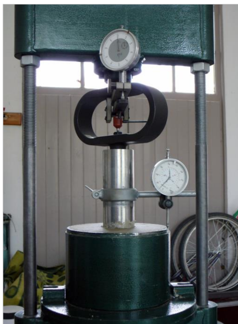
4. ábra: CBR-vizsgáló készülék. Figure 4: CBR testing apparatus.
