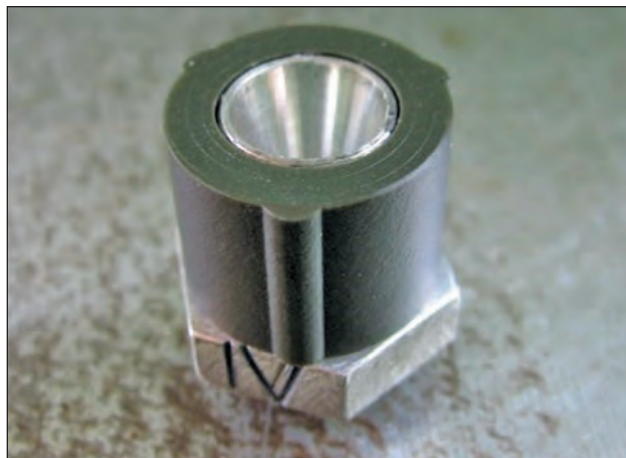
14. ábra. Fúvóka a PGR-69M lőporával szerelve
