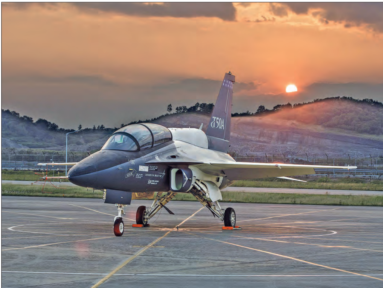
6. ábra. A Lockheed Martin és a Korean Aerospace Industries a T-50 Golden Eagle kiképző repülőgéppel nevezett a T-X tenderre. A képen látható repülőgép törzsén a gerinctartály opcionálisan felszerelhető légi utántöltő-berendezéssel
