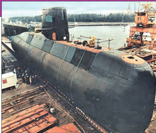
4. ábra. Épül a TR 1700 típusú tengeralattjáró az emdeni hajógyárban, Németországban. Jól látható a precízen tervezett áramvonalas hajótest és a torony a kormánylapokkal. A második világháború után épített legnagyobb német tengeralattjáró, kategóriáján belül az egyik legkorszerűbb volt az 1980-as években. Rendszerezésével az argentin flotta jelentős technológiai fölényt szerzett a riválisokkal szemben
