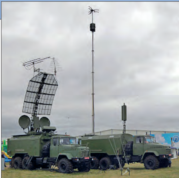
6. ábra. A Kolchuga passzív radar egyik mérőpontja [4,12]
