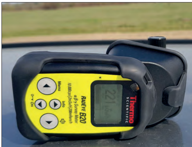
5. ábra. A minta aktivitásának mérése a kísérlet megkezdése előtt
