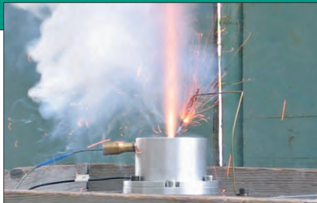
21. ábra. A beinduló rakétalőpor kifújja az égő füstös lőpor szemcséket
