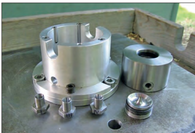
12. ábra. A mérőhajtómű főbb elemei
