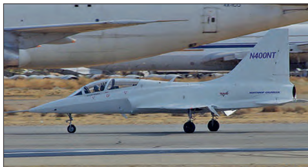
4. ábra. A Modell 400-as a Northrop Grumman és a Scaded Composites közös terméke. Az N400NT egy kompozit T-38-as újragondolás. A Grumman végül visszalépett a T-X tenderen történő indulástól
