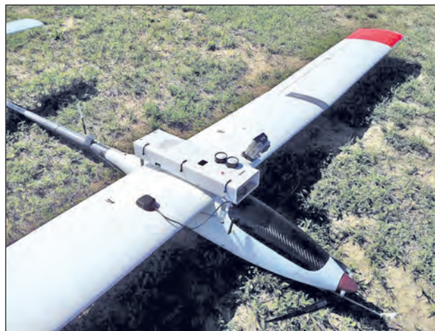
1. ábra. A Chelidon nevű, saját fejlesztésű robotrepülőgépre szerelt mérőmodul
