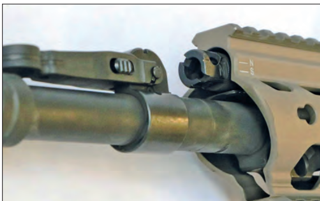
4. ábra. A módosított mellső markolat könnyű hozzáférést biztosít az állítható gázátömlés-szabályozóhoz
