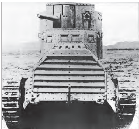
5. ábra. Az LK II-es forgótorny nélküli, 57 mm-es ágyúval szerelt változata. Jól látszik az LK I-esről örökölt hátrafelé dőlő orr-rész, amelyen még nyitható-zárható páncélzsálaton keresztül áramolhatott a motor hűtését biztosító levegő a motortérbe
