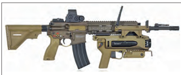
2. ábra. HK416A5-ös gépkarabély EOTech optikai irányzékkal és GLM gránátvetővel
