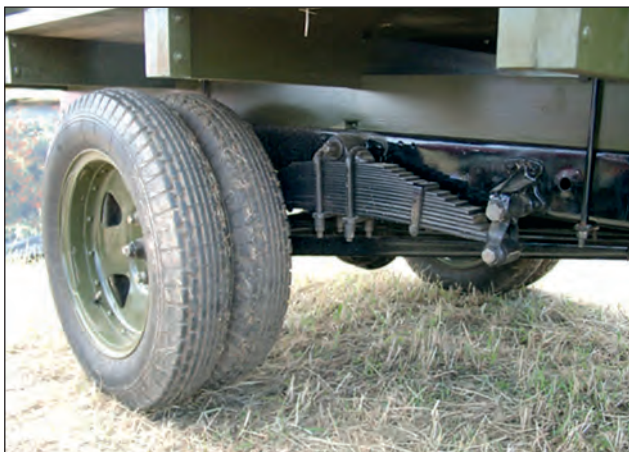
7. ábra. A hátsó híd laprugójának beépítése
