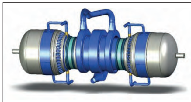
4. ábra. A duál Stirling-motoros energia-konverter vázlatrajza
