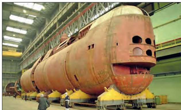
8. ábra. Az ARA SANTA CRUZ osztály be nem fejezett példányainak „maradványai” az argentin tandanori hajógyár csarnokában. Az építés különböző fázisaiban megrekedt tengeralattjárók jobb híján alkatrészforrást jelentettek a két működő egységnek
