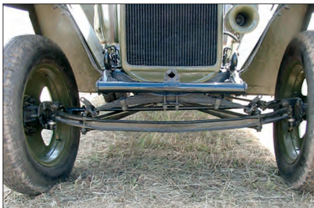
6. ábra. A késői egyszerűsített, első (fék nélküli) futómű
