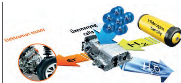
2. ábra. A hidrogéncellás hajtás sematikus ábrázolása
