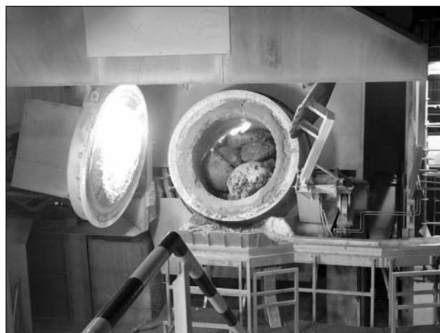
■ 4. ábra. Salak-visszaolvasztás forgódobos kemencében
