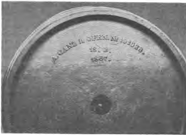
4. Kéregöntésű vasúti kerék 1967-ből Ein mit Schalen guss verfertigt Eisenbahnrad aus 1867
