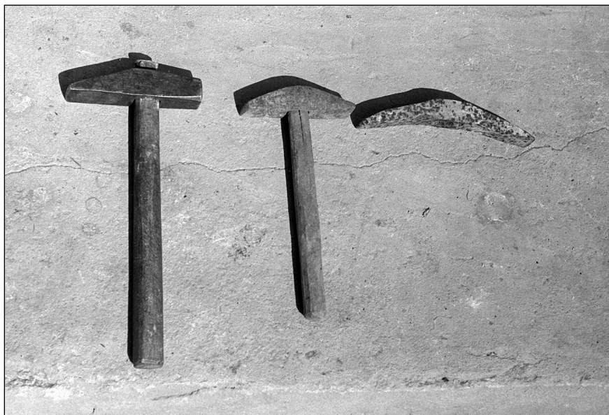
3. kép. Kaszaverő kalapácsok, jobbról: régi forma díszítéssel, újabb, legújabb (gyári). Fotó: Halász Péter 1974, Pusztina.
