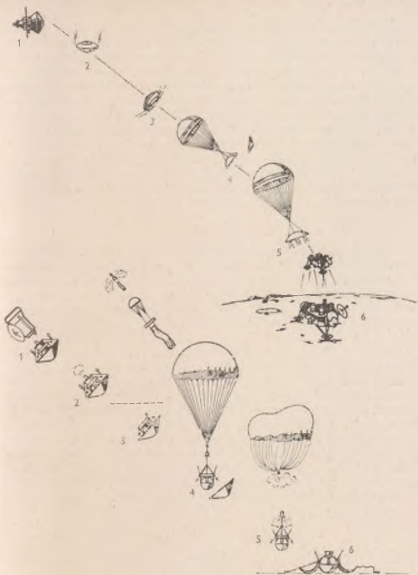
23. ábra. A Mars felszínre történő sima leszállás fázisai az amerikai VIKING '75 űrszondák (a) és a szovjet Marsz típusú űrrakéták (b) esetében: 1 — a leszálló egység leválasztása; 2 — leszálló pályára állás; 3 — aerodinamikus fékezés; 4 — fékezőpajzs ledobása — ejtőernyős ereszkedés; 5 — az ejtőernyő leválasztása — rakétás leszállás; 6 — sima felszint érés — a műszerek és berendezések üzemelni kezdenek.
