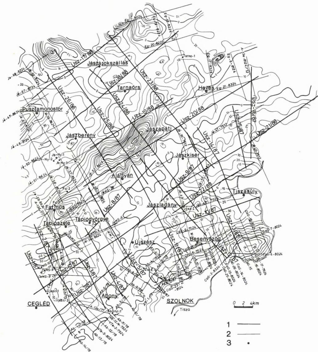
20. ábra. A jászsági szeizmikus mérések helyszínrajza a mágneses \Delta Z -anomália térképen 1 — 1987–88. évi szeizmikus reflexiók vonal; 2 — régebbi szeizmikus reflexiók vonal; 3 — mélyfúrás
