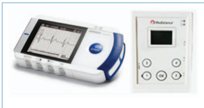
4. ábra. OMRON Heartscan HCG-801 mobil-EKG. Jobb-oldalt az adattovábbító hub
