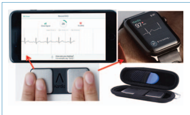
3. ábra. AliveCor rendszer. A 60 g-os kis felvevő szenzor (jobb oldalt alul). A jobb és bal kéz ujjai a szenzoron (bal oldalt alul). Fent: okostelefon és okosóra
