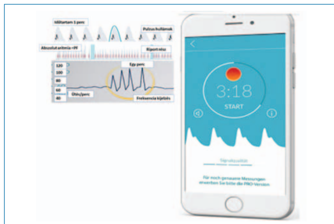
2. ábra. Preventicus Heartbeat rendszer pitvarfibrilláció észlelésére pulzusszámlálással
