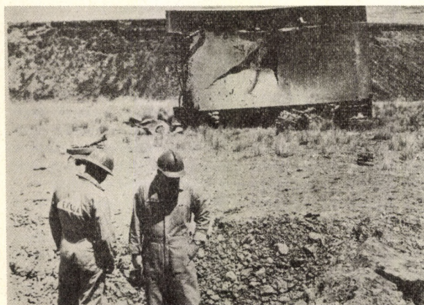
Páncélozott jármű a kísérlet előtt és az Astrolite-G kiöntésével készített akna robbantása után
