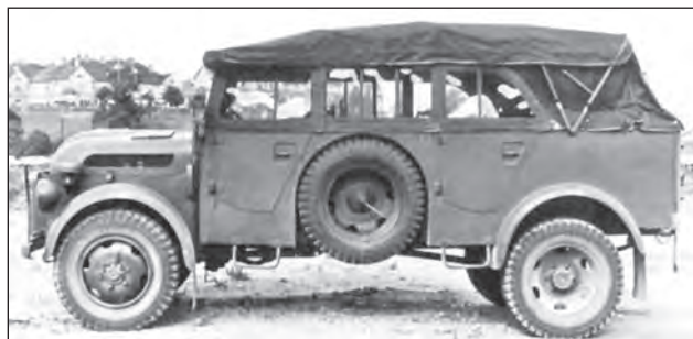
8. ábra. A rajkocsi korábbi – külső pótkerekes – kivitele
