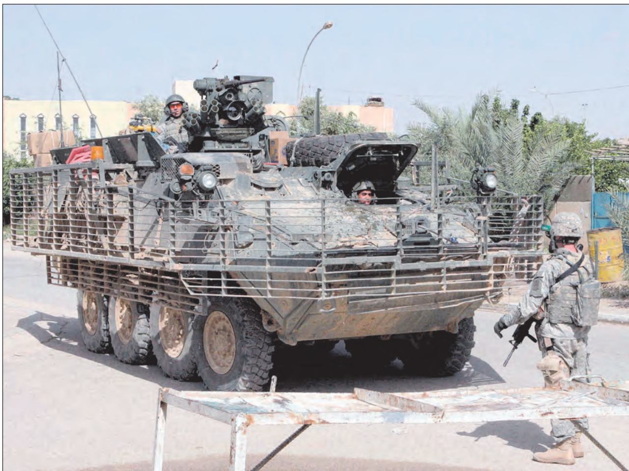
7. ábra. Stryker harcjármű, kézi páncéltörő rakéták ellen felszerelt védőráccsal
