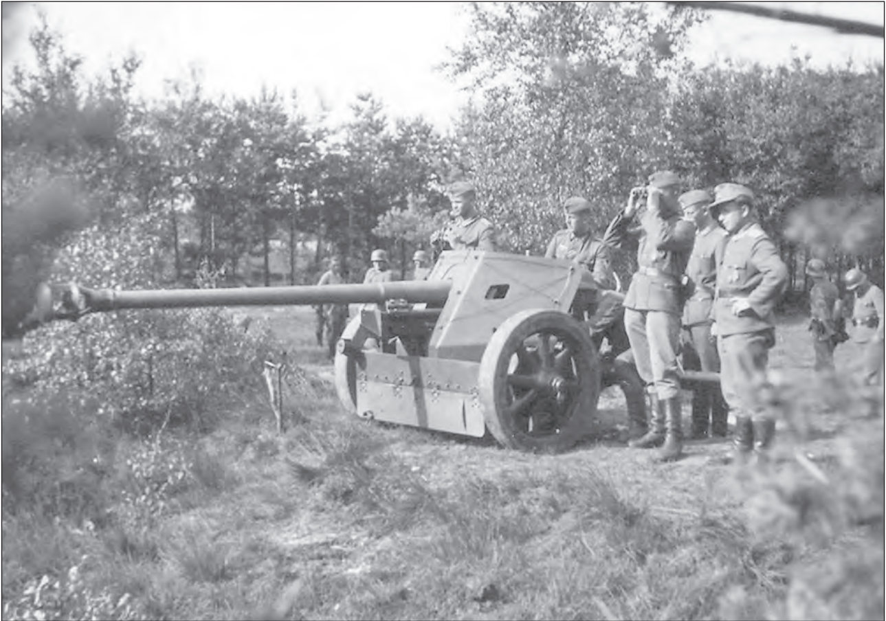
9. ábra. A 7,5 cm-es páncéltörő ágyú 1 km távolságból is meg tudott állítani egy szövetséges közepes harckocsit, viszont a mozgatásához már kisebb távolságon sem volt elég csak a kezelőszemélyzet
