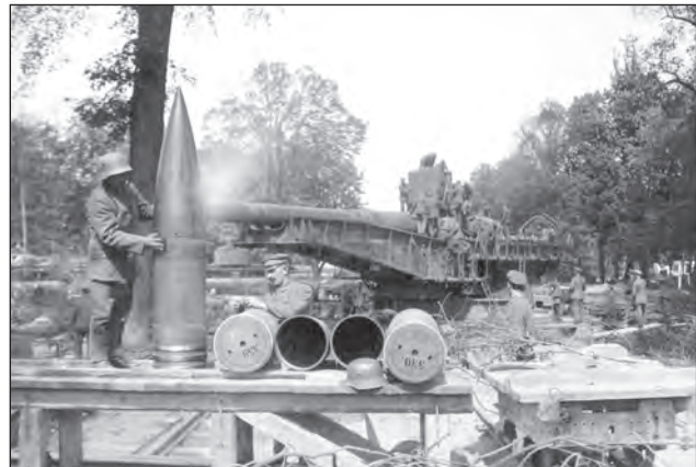
2. ábra. A befejezetlen nagy hadihajók hamarabb elkészült ágyúi több hadviselő nemzetnél is a vasúti tüzérséghez és/vagy a partvédelemhez kerültek. A Langer Max 38 cm-es vasúti ágyúkat eredetileg a BAYERN osztály utolsó két csatahajójához szánták
