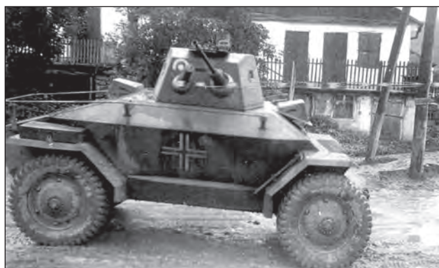
6. ábra. Csaba páncélgépjármű, jobbra fordított toronnyal
