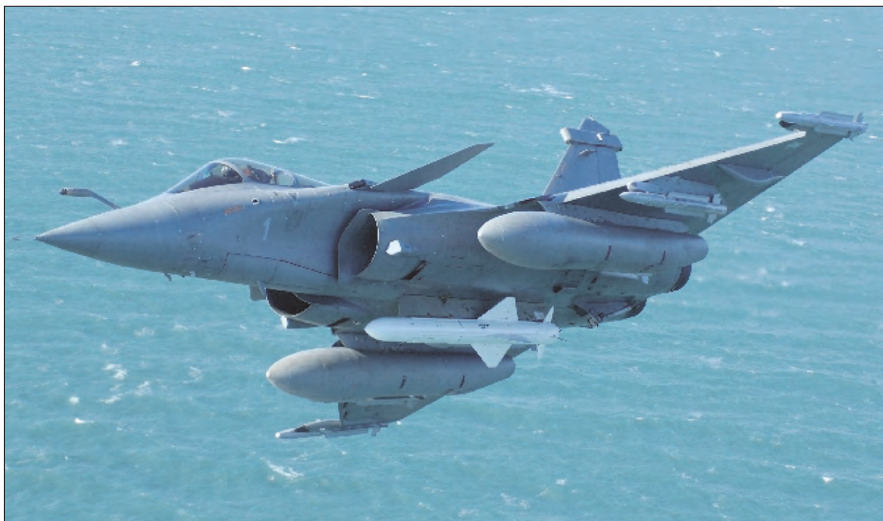
30. ábra. A CHARLES DE GAULLE repülőgép-hordozónak nemcsak a meghajtása nukleáris. A Rafale M gépek rendelkezésére áll a franciák végítélet-fegyvere az ASMP-A termonukleáris robbanófejjel felszerelt 500 km hatótávolságú szuperszonikus sebességű támadórakéta. A képen látható központi függesztmény csak súlymakett, békehelyzetben még gyakorló riadók esetében sem repülhetnek az igazi rakétákkal
