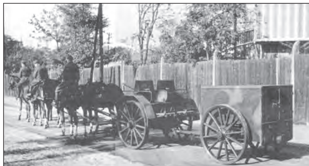
1. ábra. Az Uhri-testvérek cége által gyártott nagy lőszer félkocsi, amelynek vontatására négy lovat alkalmaztak
