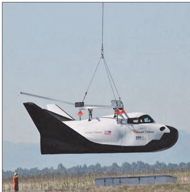
5. ábra. A Sierra Nevada Corporation űrrepülőgépe függesztt, légköri siklásos próbán
