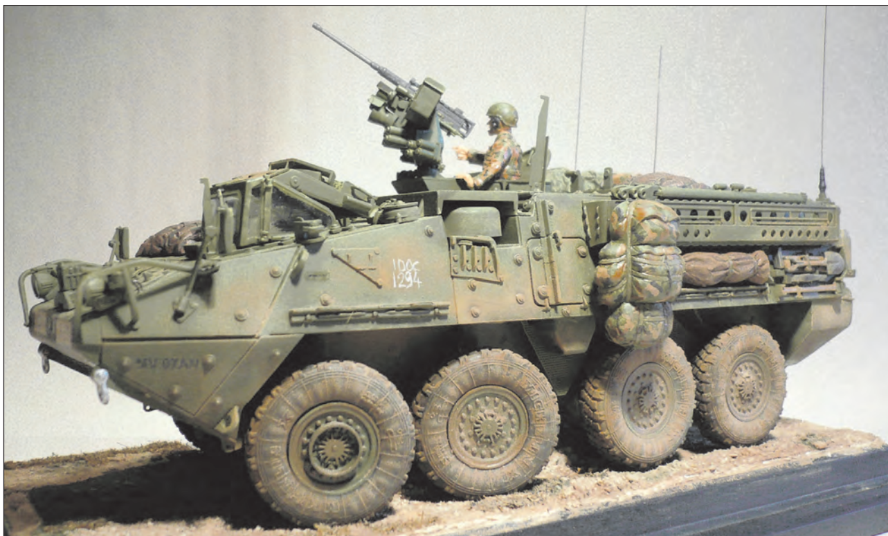
4. ábra. A páncélozott lövészszállító harcjármű bal oldala. A Stryker páncélzata 10-15 mm hengerelt acélpáncélból kialakított kerámia- és Kevlar-betétes, réteges szendvicspáncélzat
