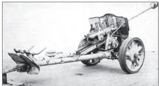
10. ábra. Az eredeti 7,5 cm-es Pak 40-es 1 km távolságból is képes volt egy szövetséges közepes harckocsit megállítani. A megnövelt csőemelésű 7,5 cm-es FK 7M85-ös könnyű hadosztályágyúból csak 10 db készült a háború vége előtt
