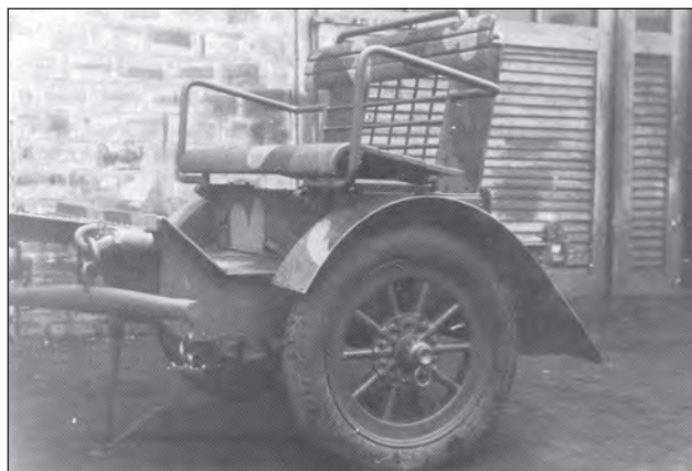
6. ábra. A könnyített szerkezetű Uhry-féle lövegmozdony az alumínium kerékagyas, fűvott gumitömlős kerékkel
