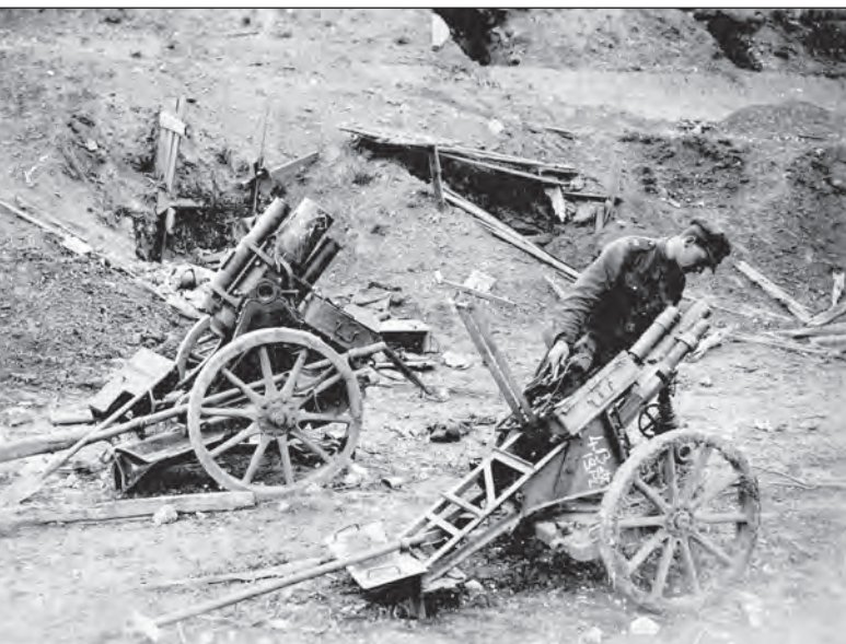
3. ábra. A 7,58-as és 17 cm-es aknavetők (Minenwerfer) a császári haderő számára komoly előnyt biztosítottak az állásháborúban az antant csapataival szemben
