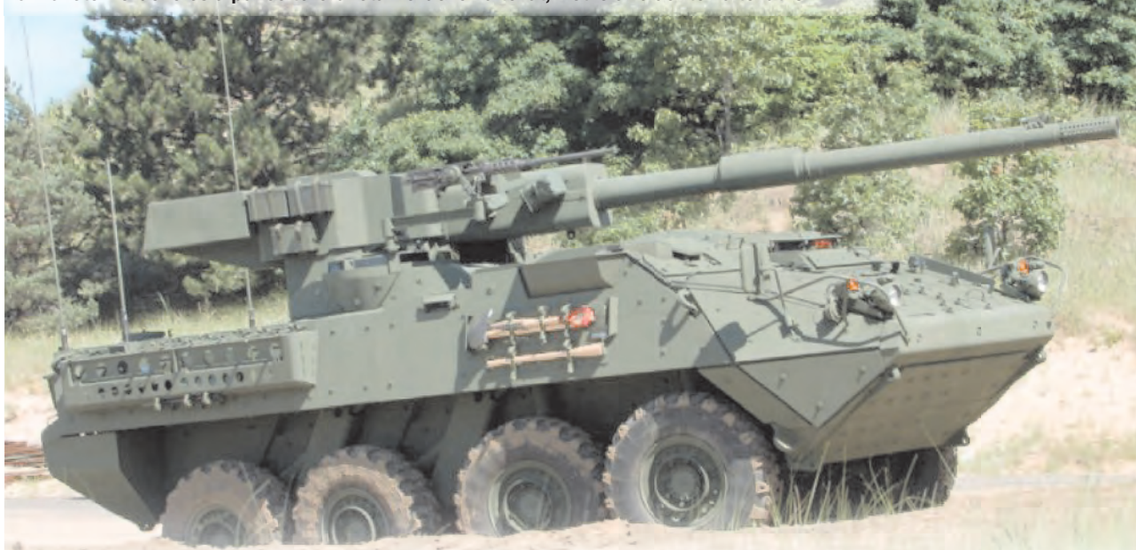
1. ábra. A Stryker páncélozott harcjármű 105 mm-es harckocsi-ágyúval felszerelt M1128-as változata. A Stryker harcjármű-családban emellett megtalálható a lövészszállító, a 120 mm-es aknavető-hordozó és a páncéltörőrakéta-hordozó változat, illetve a felderítő változat is
