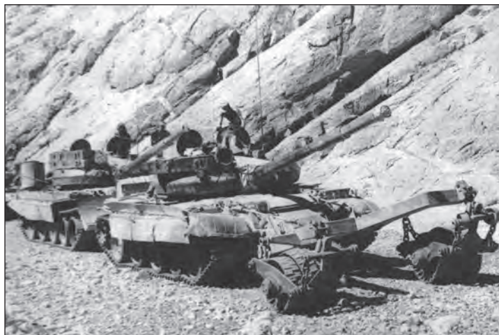
21. ábra. T-62 AM harckocsik az afgán hegyek között. Az elől haladó harckocsit görgős aknamentesítő szerelvényt látták el
