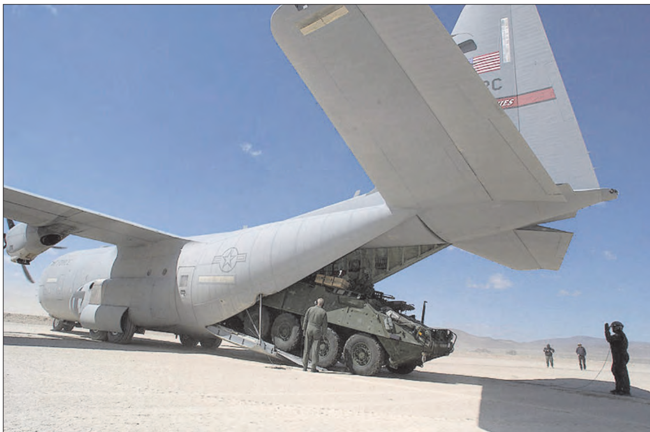
6. ábra. Stryker harcjármű deszantolása C-130-as szállító repülőgépből. A Stryker-dandárok alapvető képessége a légi szállíthatóság
