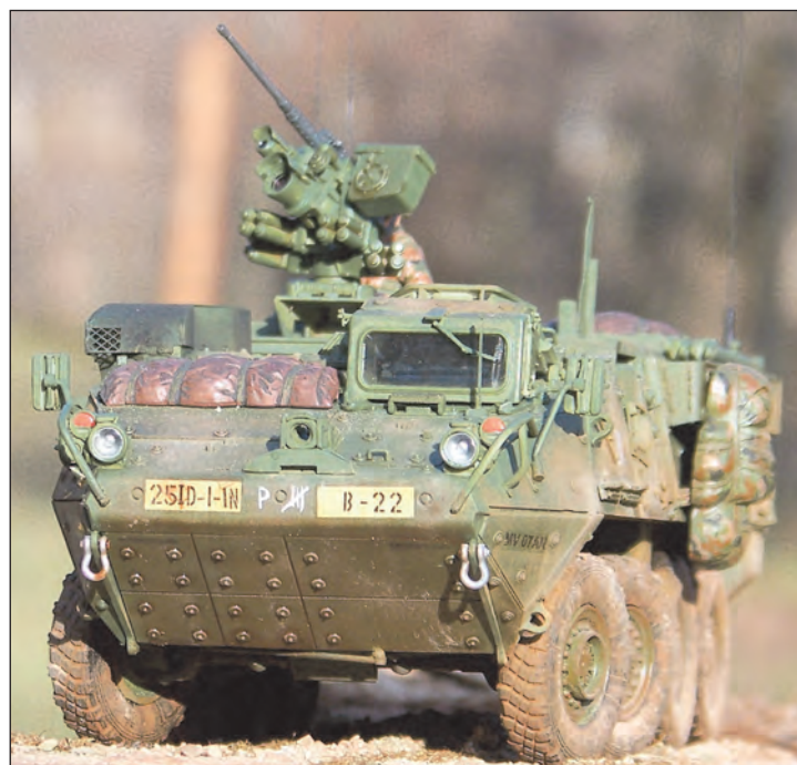
3. ábra. A képen jól látható a Kongsberg M151-es Protector távirányítású fegyvertorony és az M2 12,7 mm-es kaliberű géppuska
