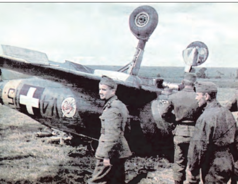
2. ábra. A bevetésről visszatérő V.415-ös oldalszámú Héja leszálláskor átvágódott. A frontra kivevényelt Héják sérüléseinek és veszteségeinek többsége balesetből adódott. A felfelé meredő bal futószár mellett látszik a felszerelt Nardi bombatár (2 db közvetlenül egymás mellett), attól jobbra a fényes hengeres test az olajhűtő, amelynek áramvonalazó burkolata leszakadt
