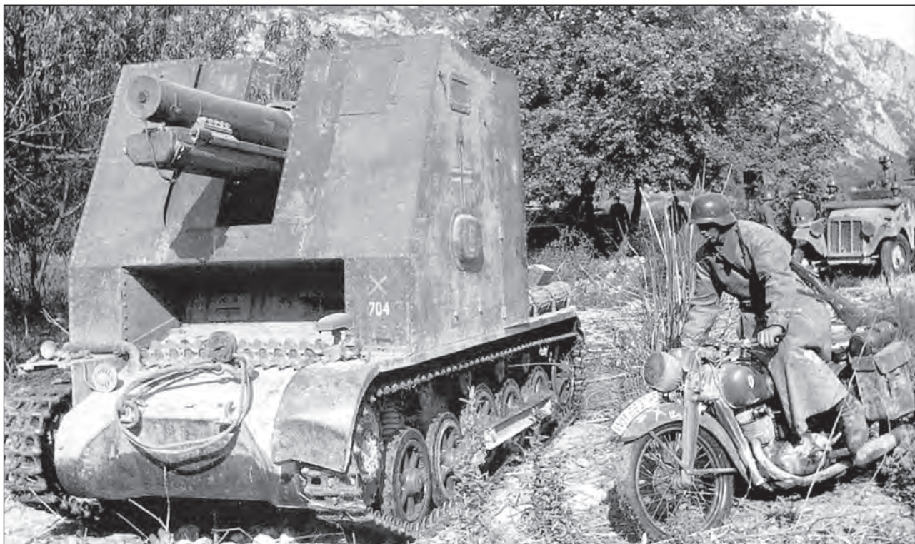
6. ábra. A Panzer II alvázán gépesített 15 cm-es gyalogsági ágyú volt a Sig 33-as „Bison”
