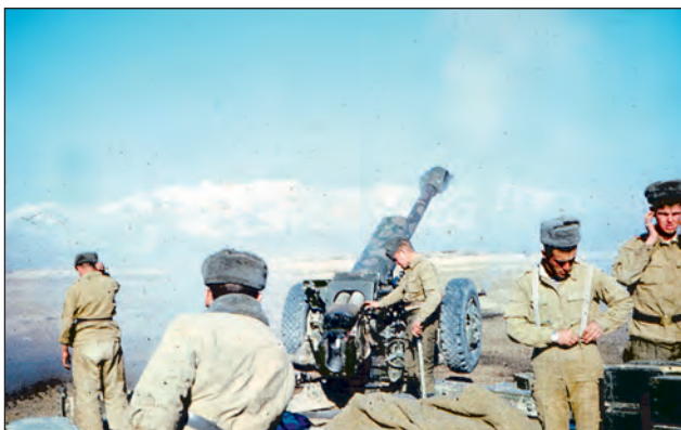
27. ábra. Szovjet D-30-as tarack afganisztáni tüzelőállásban. Az 1963-ban rendszeresített 122 mm-es tarack 15,4 km távolságra tüzelhetett
