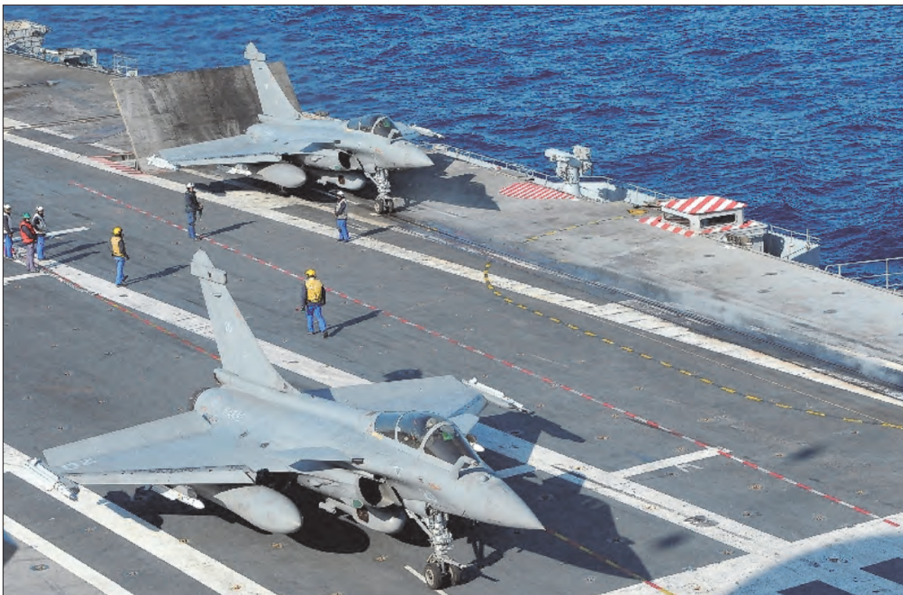
20. ábra. Dassault Rafale M vadászbombázók start előtt. A gépeken MICA légharcrakéták, póttartályok és a törzs alatti pylonon RecoNG (AEROS) felderítő konténerek
