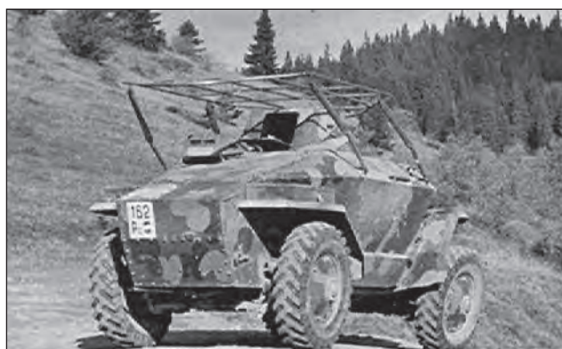
3. ábra. Keretantennás Csaba páncélgépkocsi prototípusa, terepen történő próba közben (HF)
