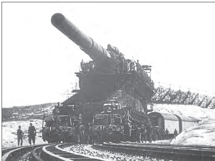
19. ábra. A Dora vasúti löveg összeszerelve, tüzelési pozícióban egy négyszeres vasúti vágányon. A mögötte látható álcázás több km-re kiterjed. A löveg vontatásához D 311 hadi mozdony volt szükséges
