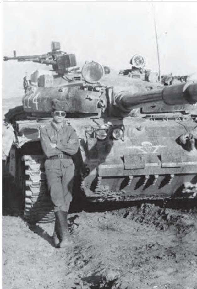
28. ábra. Szovjet katona egy T-62-es harckocsi előtt Afganisztánban. A torony oldalán jól látszik a kiegészítő páncélzat. A torony tetején 12,7 mm-es DSK géppuska látható
