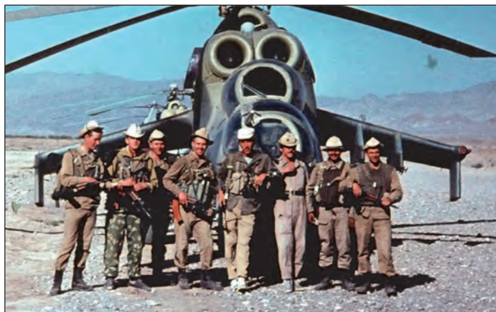
22. ábra. Szovjet Mi-24-es harci helikopter Afganisztánban. Az erős támogató fegyverzetrel ellátott harci helikopter deszant-terében 8 fő lövészkatona szállítására is alkalmas volt. A képen egy Specnaz-raj látható
