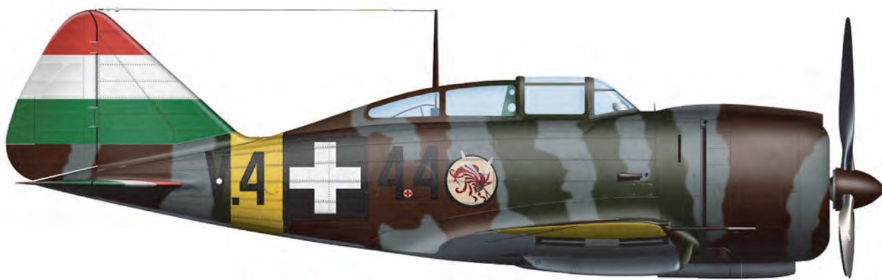
26. ábra. Reggiane Re.2000, V.444 (N.C. 310), az 1/1. „Dongó” vadászpilóta-századtól átvett gyakorlórepülő, 1943. Hadiszínek (Cellaetern festékek a Krayertől): kőszürke (G.1100), földbarna (G.1102) és sötétzöld (G.1103) a felső felületeken, míg világoskék (G.1101) az alsó felületeken. Felsőjel piros (G.1114), fehér (G.1115) és zöld (G.1116) a vízszintes és függőleges vezérsíkokon. Sárga törzsgyűrű és alsó szárnyvégek (C.54). (Illusztráció: Szalai Viktor, Pannon Pixels)
