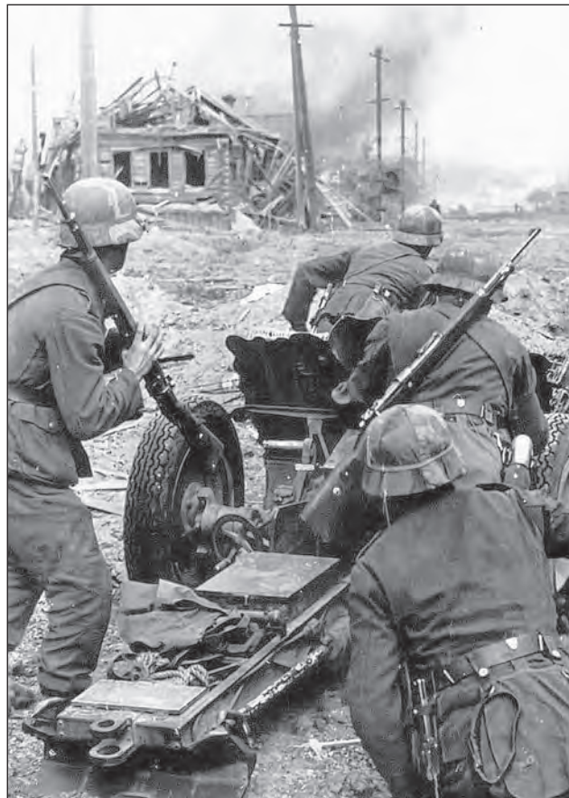
4. ábra. Akcióban a 7,5 cm le IG 18-as könnyű gyalogsági ágyú. A 7,5 cm űrméretű fegyvert a Pak 36-os páncéltörő és a PAW 600-as lövegek lövegtalpán is gyártották
