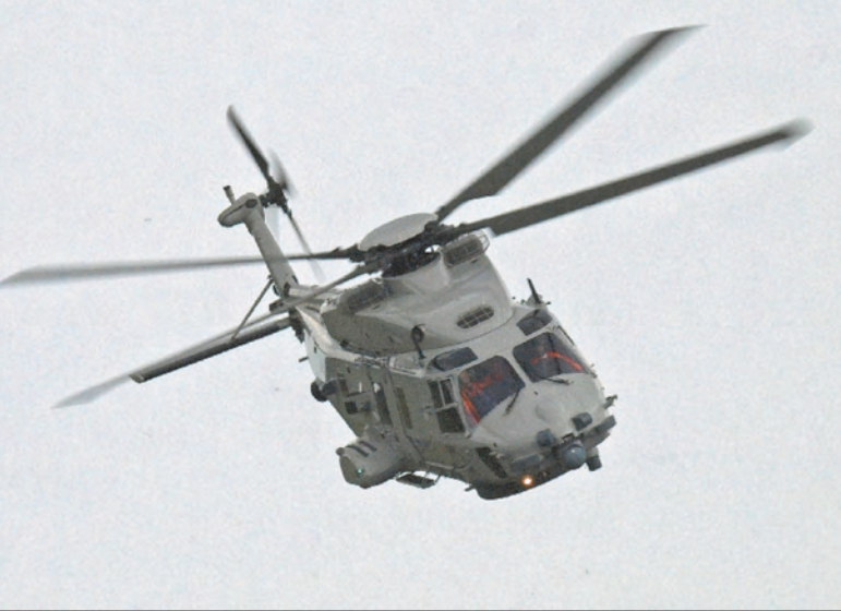
24. ábra. Az NH90 kompozitépítésű helikopter gyakorlatilag korrózióálló. A Super Frelon és a Super Puma felváltására készült a haditengerészeti változata NFH (NATO Fregatt Helicopter) néven került kialakításra
