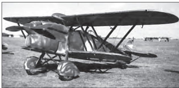
22. ábra. A kezdeti időszakban, 1938 októberétől, a világosszürke, vagy alumínium alapszínre csak sötétzöld és sötétbarna álcázószíneket fújtak rá, kötetlen stílusban, mint ahogy az ábrázolt FIAT CR.32-esen is jól látható. Az erre használt festékek minden bizonnyal a hazai Krayner és Társa cég termékei voltak
