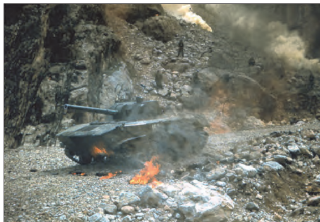
9. ábra. 2S9 Nona (SO-120) jelzésű, 120 mm-es önjáró aknavető. A 8 tonnás eszközt 15 mm páncél védi, a cső képes közvetett és közvetlen tűzkiváltásra is. A hegyvidéki harcok során a hagyományos alapharcokocsiknál nagyobb szerephez jutottak a különféle könnyű harcjárművek
