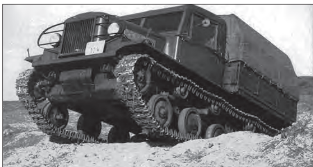
2. ábra. Tereppróbán a Cs-800-as jelű láncaltapas katonai vontató
