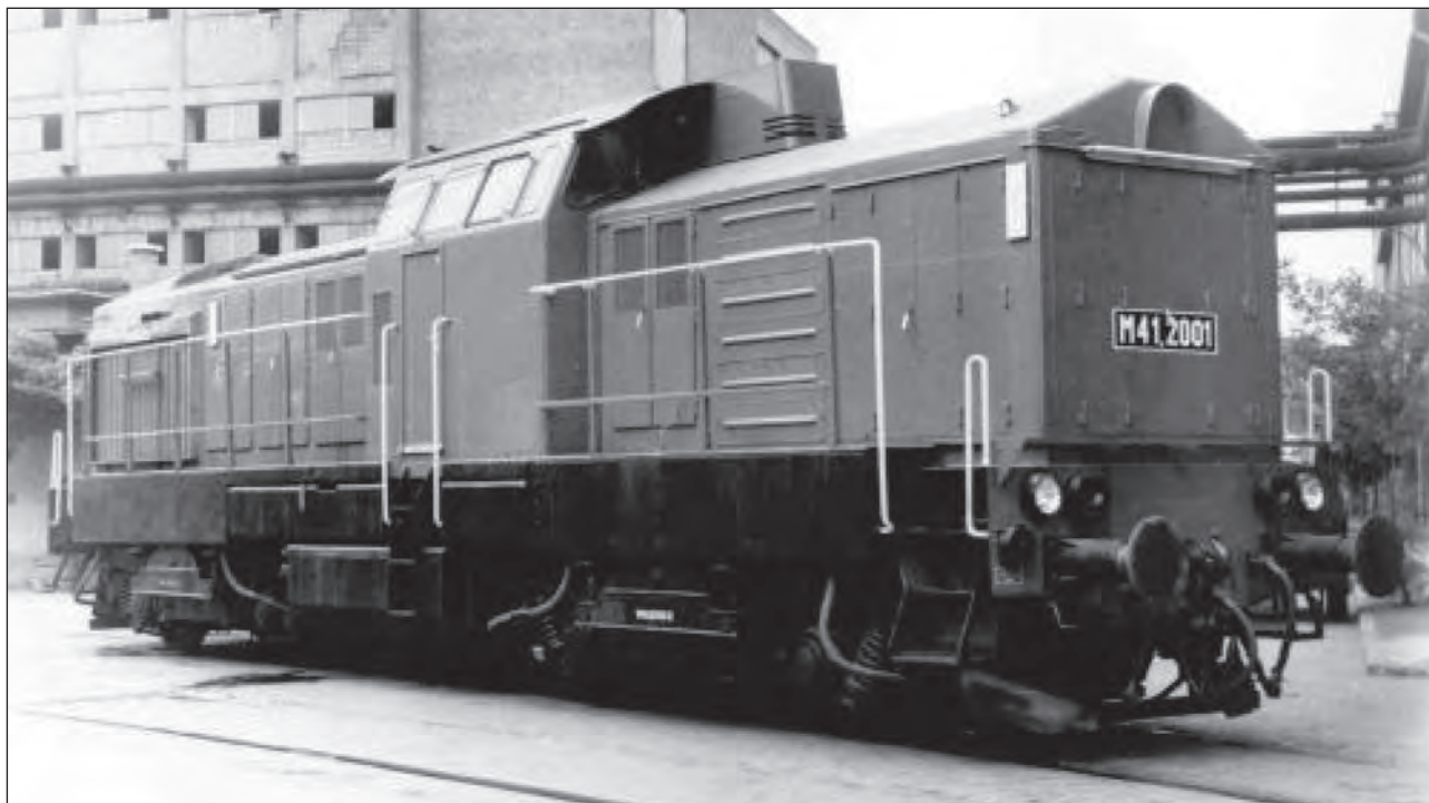
3. ábra. A DHM5 M41, 2001 kísérleti mozdony a V12 motorral
