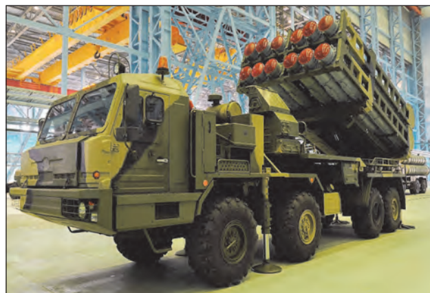
74. ábra. Sz-350-es Vityaz rakétarendszer 50P6A szállító-indító jármű BAZ-69092-012-es alvázon
