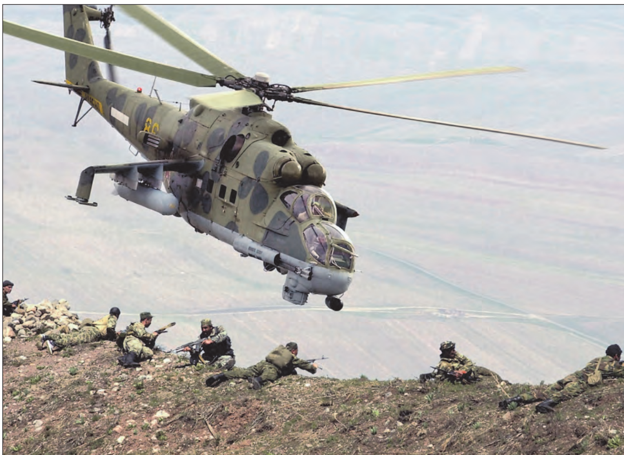
2. ábra. A szovjet haderő Mi-24-es helikopterei kulcsszerepet játszottak az Afganisztánban vívott háború során. A fotón látható helikopter törzs-orrész jobb oldalán jól látható a kétsövű 30 mm-es gépágyú
