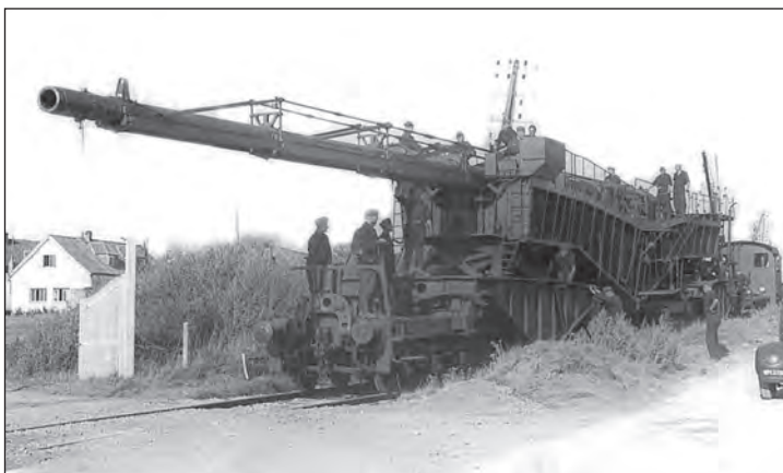
15. ábra. Egy K 12 típusú távolharc löveg 1944-ben Boluogne közelében volt állásban. A vontató mozdonya a WR 360 C14. A löveg lőtávolsága 115 km, tömege 300 t volt
