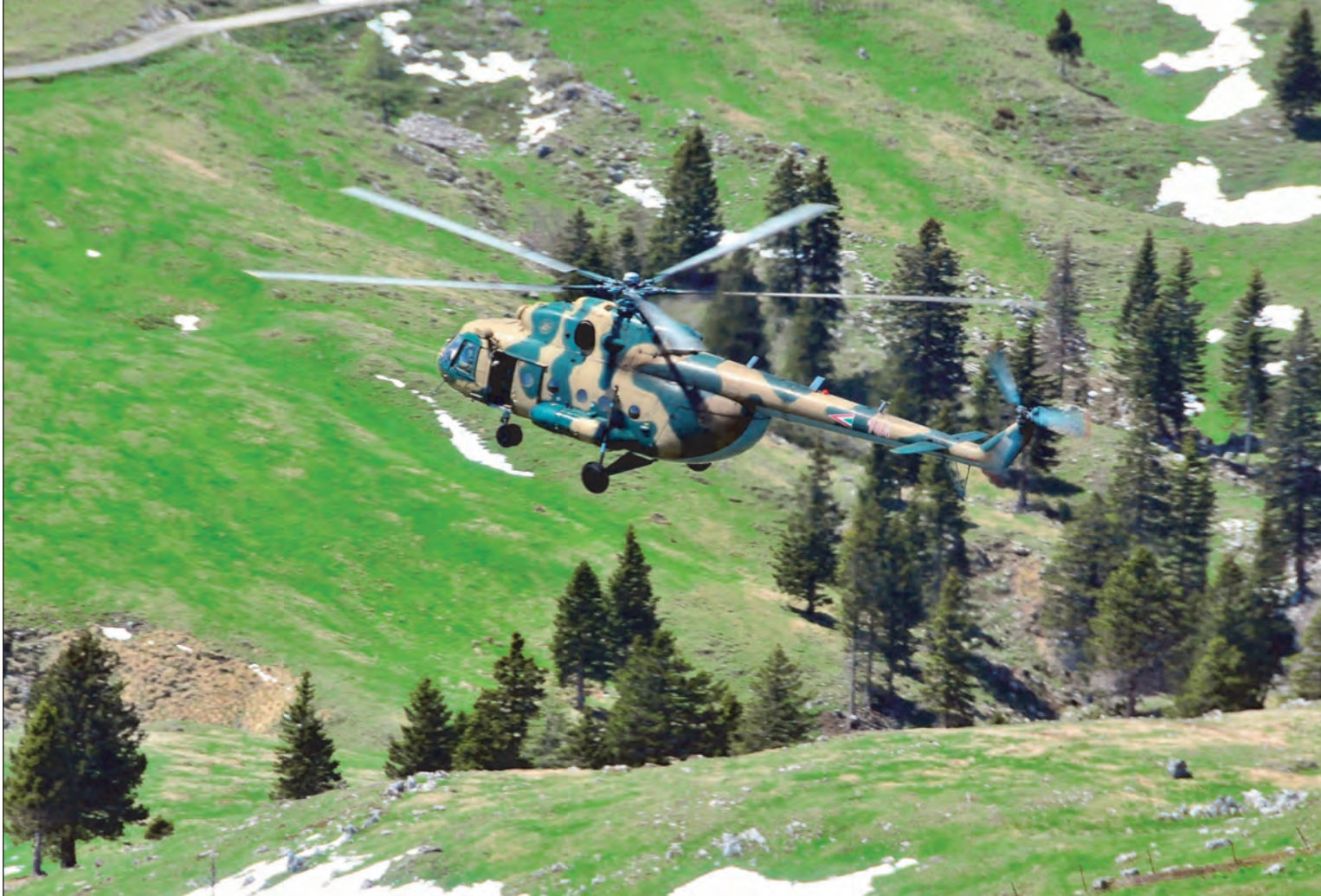
5. ábra. A „híg” levegőben a helikopter tehetetlensége is jelentősen megnő, ami különösen a fékezés fázisában jelenthet gondot
