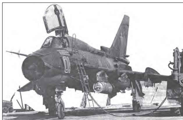
6. ábra. A szovjet légierő Szu-22-es harci repülőgépe a részben állítható állásszögű variaszárny és a mintegy 4 tonnás fegyverzeti terhelhetőség, illetve a függeszthető gépágyúkonténerek és rakéta-blokkok miatt jelentős szerepet játszott a szárazföldi csapatok közvetlen támogatásában az afganisztánban vívott háború során
