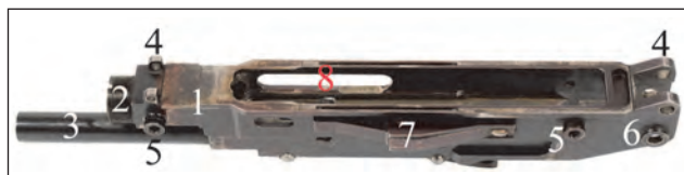
16. ábra. A tok 1. tok, 2. csőfarrögzítő, 3. gázdugattyú-vezető, 4. tokfedélrögzítő, 5. bölcshőrgzítő, 84 6. elsütőszerkezet-rögzítő, 7. kivető, 8. kivetőnyílás
