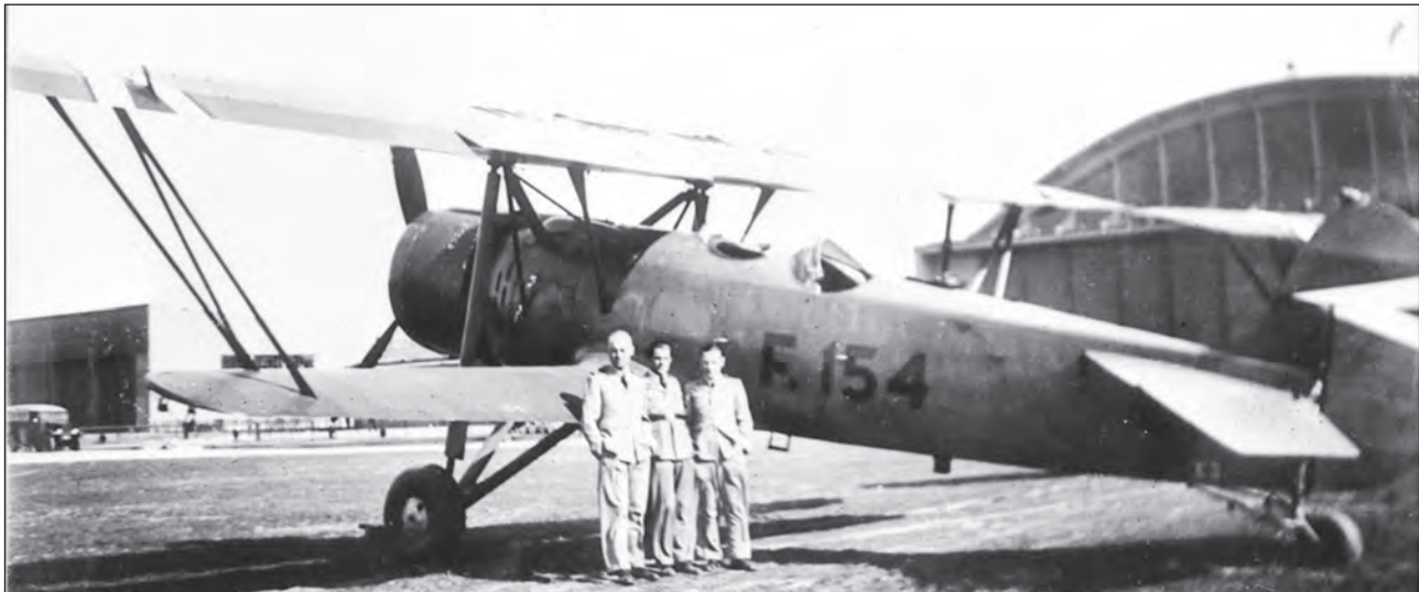
14. ábra. Az első sorozatban gyártott magyar katonai repülőgépek a Fokker C.V D alapján kifejlesztett, 1934-ben gyártásba került WM-16A/B „Budapest” (Bp-9-es és Bp-14-es) felderítő/bombázók voltak. Korabeli társaikhoz hasonlóan, ezeket a repülőgépeket is különböző árnyalatú világosszürkére festették
