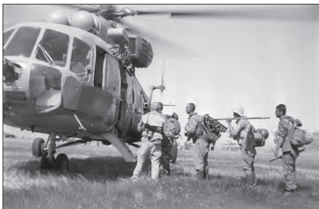
4. ábra. Az afganisztáni háborúban jelentős szerephez jutott a helikopteres légimozgékonyság és a szovjet haderő olyan különleges műveleti elemei, mint a Szpecnaz. A Mi-8-as helikopter hajtóművének gázvezető csövén egy hideg levegős hőelkeverő berendezés látható, a hőkövető rakéták ellen
