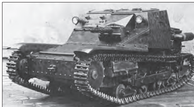
2. ábra. A kétfős személyzetű 3,2 tonnás Ansaldo kisharckocsit Magyarországon 8 mm-es Gebauer ikergéppuskával szerelték fel
