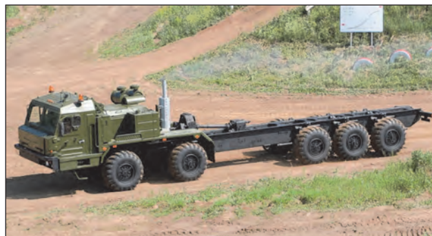
70. ábra. BAZ–69096-os alváz, terepróbnán
