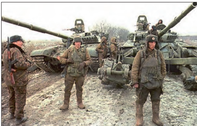
5. ábra. T-72-es harckocsik Afganisztánban, a jobb oldali harckocsi aknamentesítővel felszerelve. A páncélos csapatok műveletei kevésbé bontakozhattak ki a hegyvidéki környezetben, illetve a gerillákkal vívott harcok során. A bal oldali katona 5,45 x 39 mm-es AK-74-es gépkarabéllyal, a közepén álló katonának korai lövedékálló mellénnyel vannak felszerelve
