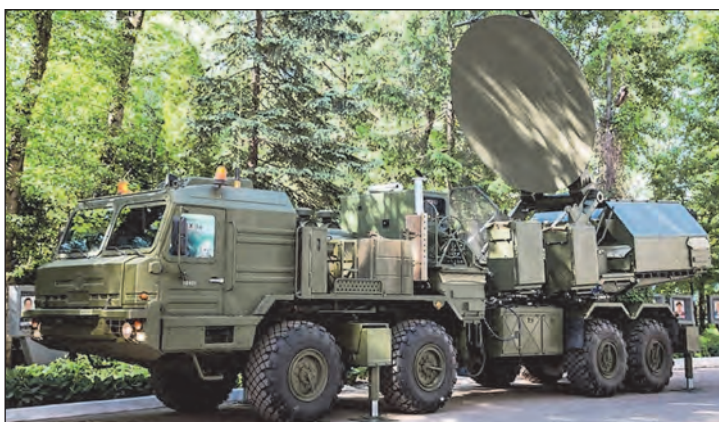
73. ábra. 1L269-es Kraszuha-2 széles spektrumú rádióelektromos interferencia-zavaróállomás BAZ-6910-022-es alvázon
