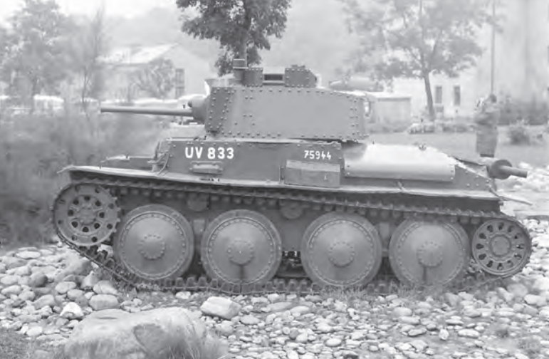
2. ábra. Ugyanazon harckocsi bal oldali képe. A futókerékpárok között megfigyelhetők a csuklósan felfüggesztett laprugókötegek
