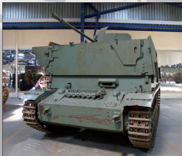
47. ábra. A PzKw IV. felépítményre szerelt 37 mm-es légvédelmi géppágyúval rendelkező páncélost Flakpanzer Möbelwagen néven gyártották
