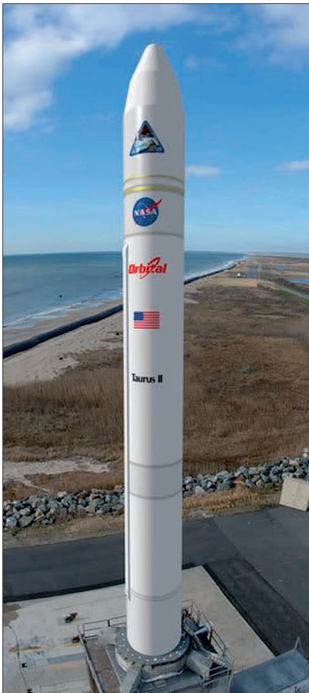
3. ábra. Taurus rakéta a starthelyen. Főbb jellemzői: 4500 kg hasznos teher 350 km-es, 51,6°-os pályára, 1400 kg geoszinkron pályára (Orbital Sciences Corp)
