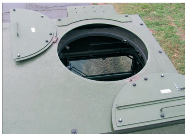
12. ábra. Tető búvónyílás kívülről
