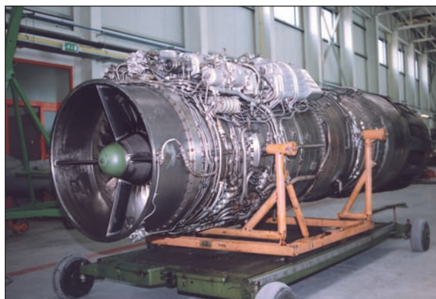
3. ábra. Beszerelésre váró RD-33 sugárhajtómű. Kecskemét, 2007. április 3.
