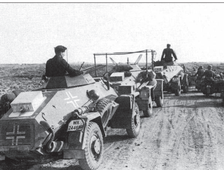
8. ábra. A fotón a páncélfelderítő egyszerre három változata is látható. A kép előterében egy Sd.Kfz 221-es, középen egy 223-as, az oszlop első járműve pedig az erősebb fegyverzetű Sd.Kfz 222-es
