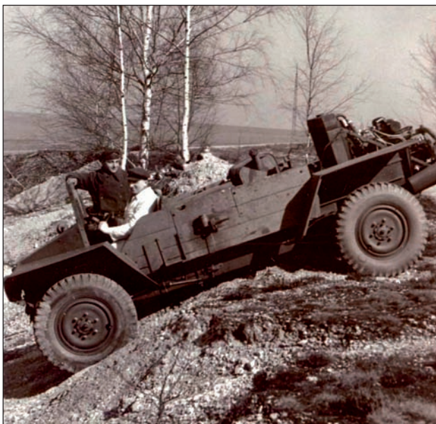
7. ábra. A farmotorral szerelt Horch önjáró alváz terepr próbája
