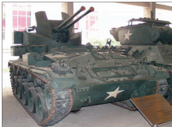
11. ábra. 40 mm-es Bofors géppágyúk amerikai lánctalpon az M19 önjáró géppágyún
