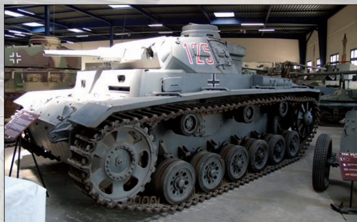
44. ábra. PzKw III. német közepes harckocsi rövid csöví, 50 mm-es ágyúval
