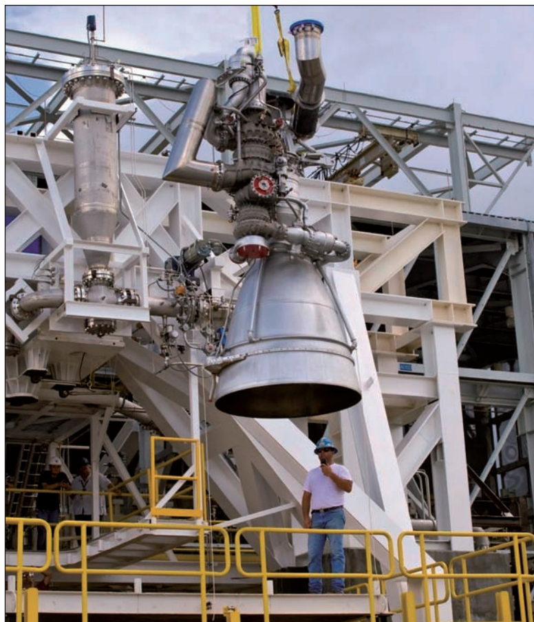
4. ábra. Az AJ-26-os hajtómű fékpadi próbája (Aerojet)
