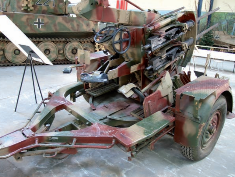
43. ábra. Német Flakvieling 38 négycsöví, 20 mm-es légvédelmi géppágyú
