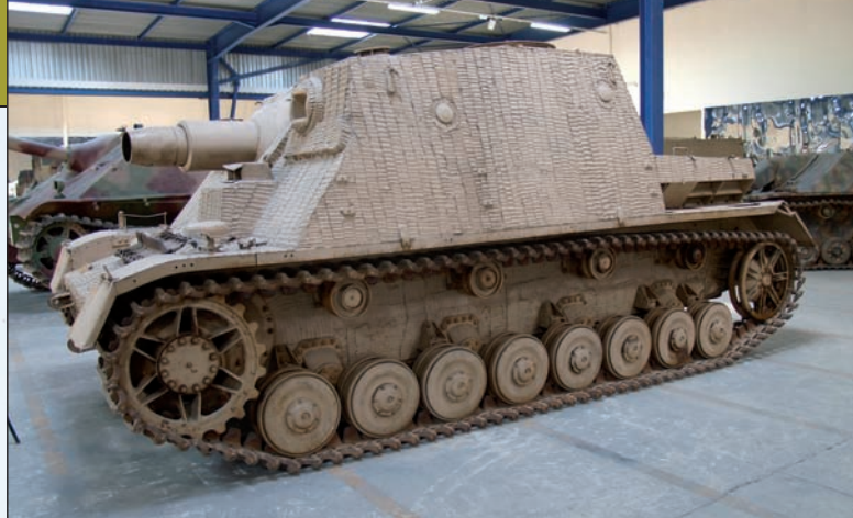
41. ábra. A német Brumbar zimmerit bevonatta a tapadóaknak ellen nyújtott védelmet. A harcjárművet városi gyalogsági harctámogatásra építették, minimális darabszámban
