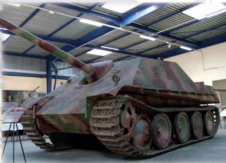
42. ábra. A szemből szinte kilőhetetlen páncélzatú, 88 mm-es löveggel épített Jagdpanther vadászpáncélos alulmotorizált volt, és kis példányszámban készült
