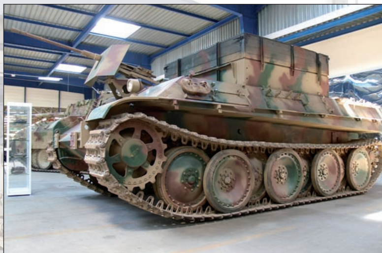
48. ábra. A PzKw V. Panther alvázra szerelt, Bergepanther műszaki harcjárműnek 20 mm-es géppágyúja ellenére, nyitott, félig fa felépítménye miatt, egy kézigránát, vagy gyalogsági lőfegyvert is elpusztíthatta a kezelőt
