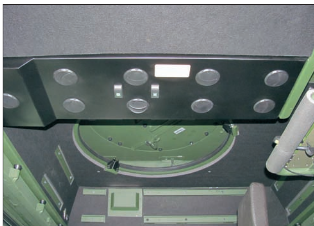
11. ábra. Tető búvónyílás és klímaberendezés
