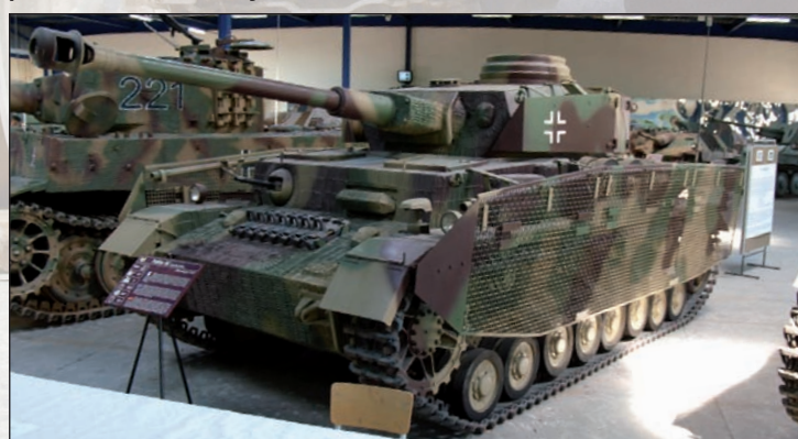
45. ábra. PzKw IV. német közepes harckocsi kiegészítő páncélzattal és kötényezéssel
