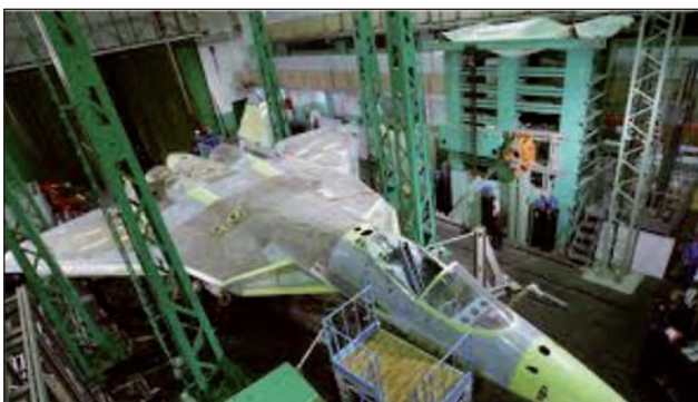
10. ábra. A második példány szerelése a rázópadai vizsgálathoz
