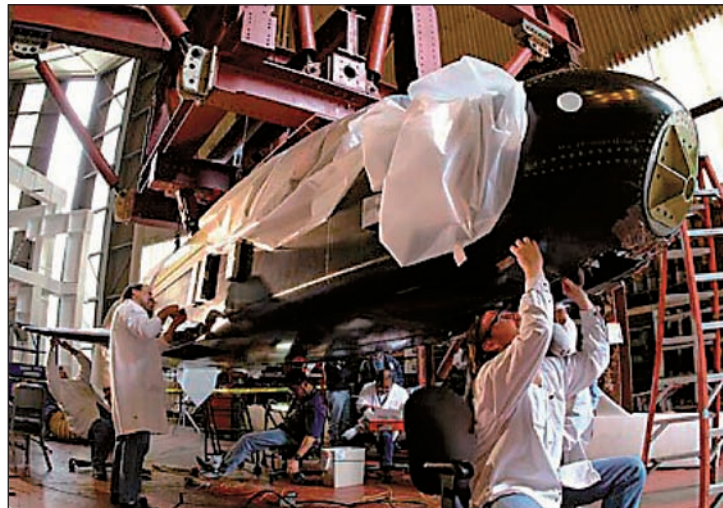
6. ábra. Az OTV-1 végellenőrzése a szerelőcsarnokában (Boeing)
