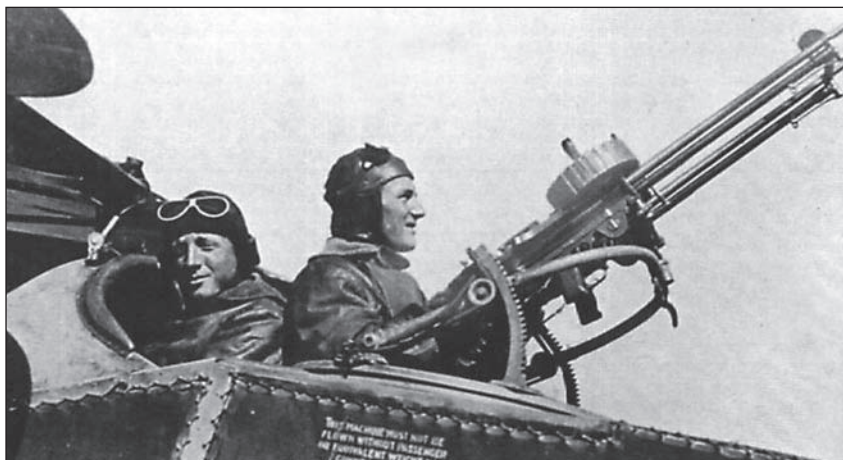
2. ábra. A Bristol F.2B vadászipülőgép két, Scarff állványra rögzített mozgatható 0,303 inches (7,7 mm-es) Lewis géppuskával
