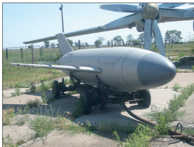
3. ábra. A Tu-16 szárnya alól indítható robotrepülőgép
