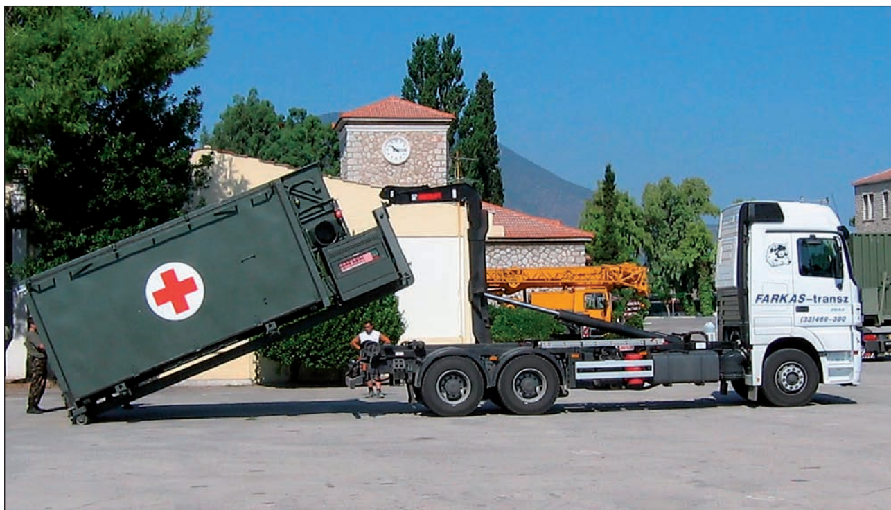
10. ábra. Biológiai labor-konténer telepítése Athénban az olimpián
