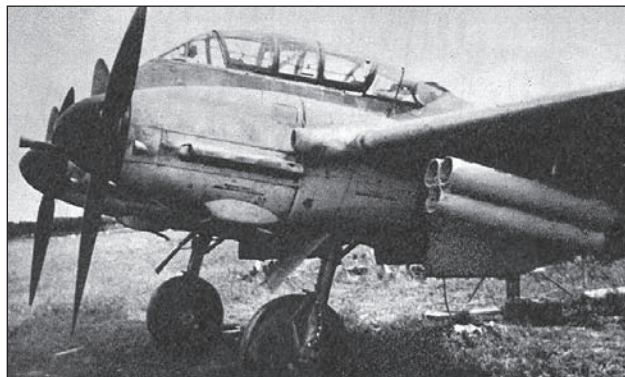
3. ábra. RKI rakétakísérlet Me 210 fedélzeti fegyverként
