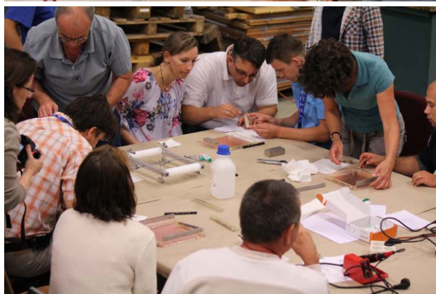
Sokszálas kamrák építése 2017-ben. Fölül Varga Dezső magyarázza a műveleteket, alul a kamratestek összeragasztása.
