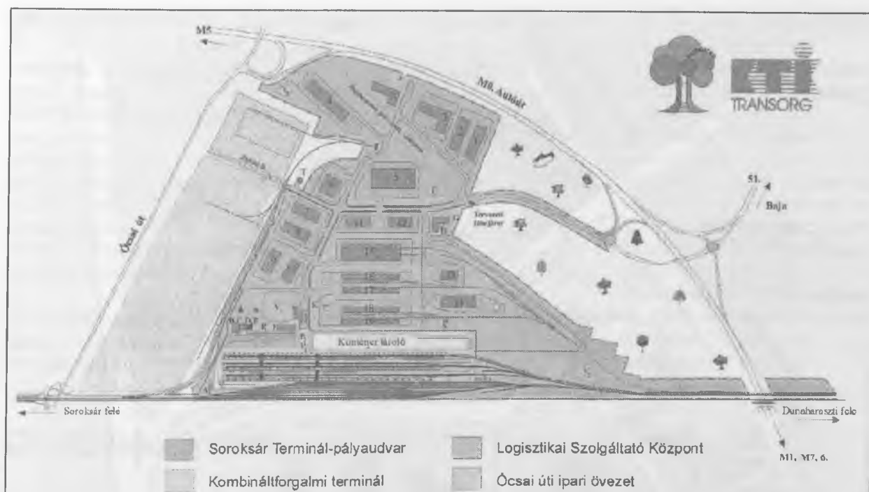
4. ábra A Budapesti Intermodális Logisztikai Központ (BILK) vázlatos elrendezési rajza
