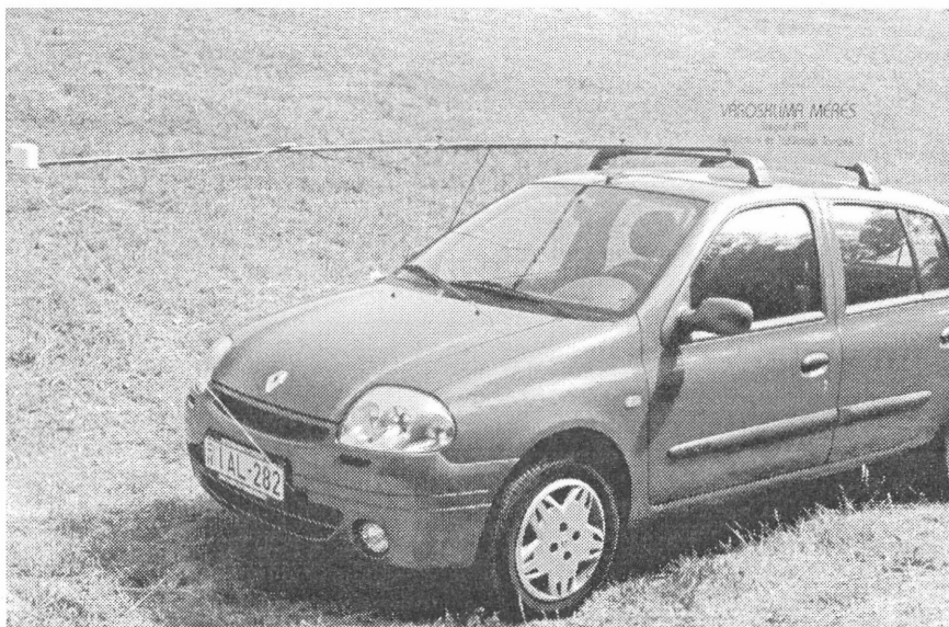
9. ábra. A mérőautó a rúdra szerelt hőmérsékleti szenzorral Figure 9. The measuring vehicle with the heat sensor on a pole
