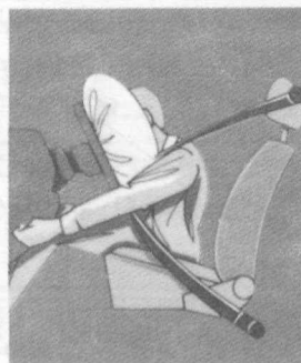
1. A légszák működési fázisai frontális ütközésnél
