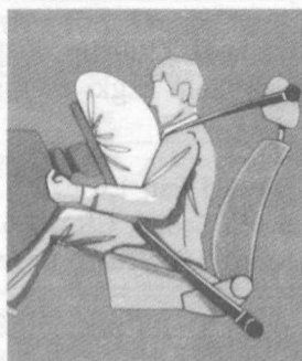
1. A légszák működési fázisai frontális ütközésnél
