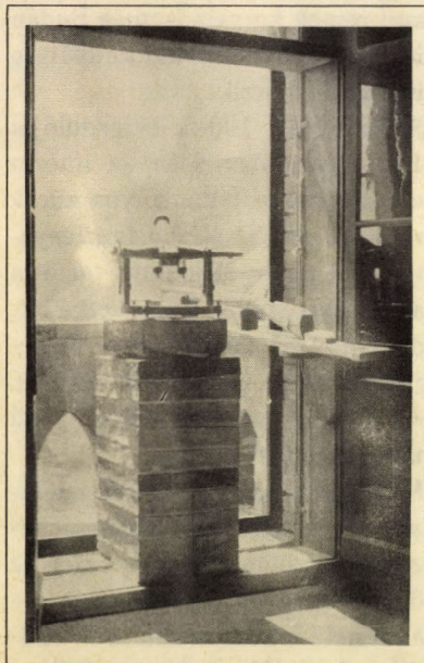
Passage-készülék, a valódi dél meghatározására. (Részlet az intézet fizikai szertárából).
