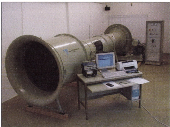
10. ábra: Szélszatorna a meteorológiai műszerkalibráló laboratóriumban
