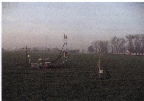
2. ábra: Mikrometeorológiai mérés (Turew, Lengyelország 2008) EU FP6 NitroEurope program SzE Optikai és Kvantumelektronikai Tsz. Fotoakusztikus Kut.csop. Metek USA-1 szónikus anemométer, középen gradien oszlop szegedi fotoakusztikus ammóniamérő, sugárázsmérők (Pogány et al. , 2010).
