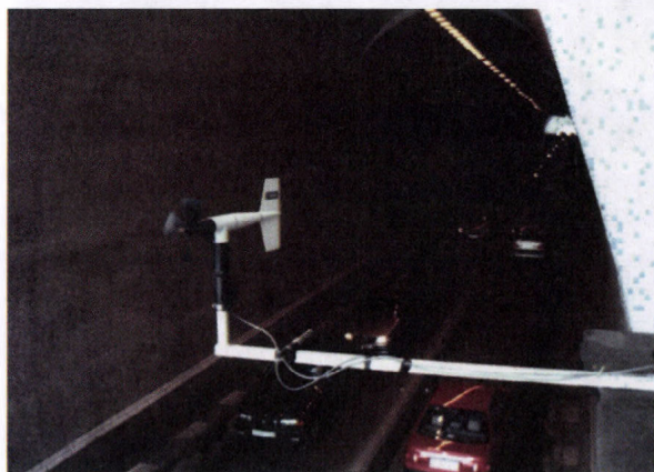
3. ábra: A várhegy alagút szellőzésének mérése levegőminőségi vizsgálatokhoz, 1999 (Salma Imre felvétele).
