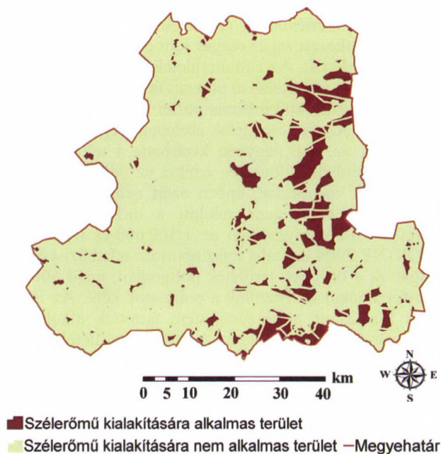
1. ábra: A szélérőművek telepítését kizáró tényezők és a körükük vont pufferzónák összesített térképe a legnagyobb pufferzónákkal számolva Csongrád megye területén
