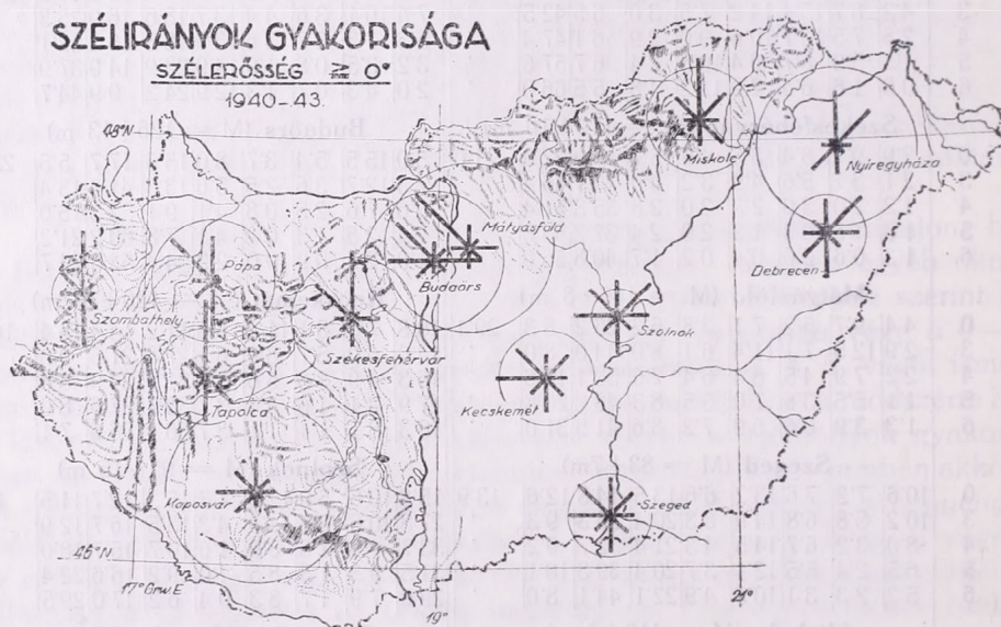
1. ábra: A szélirányok gyakorisága a repülőtereken (1940—43). — Frequency of Wind Directions on Aerodromes (1940—43).
