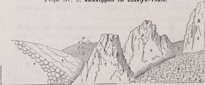
A. Syndiczava. B. Tikujata. C. Kalkblöcke. D. Steinhalde. 1. Melaphyr. 2. Kalkstein (ob. Tithon). 3. Sandstein (neocom).
