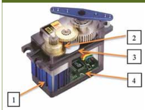
15. ábra: A szervomotor általános felépítése [16]
