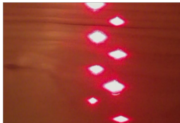
2. ábra Rávilágított és szórt lézerpontok a felületen
