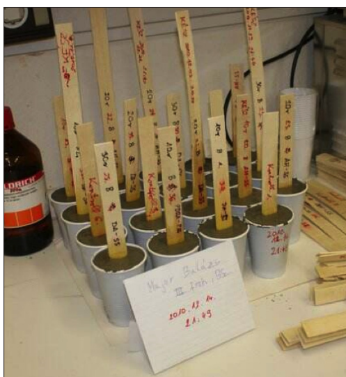
1. ábra Az LbL nanobevonatos, cement mátrixba ágyasztott nyár próbatestek
