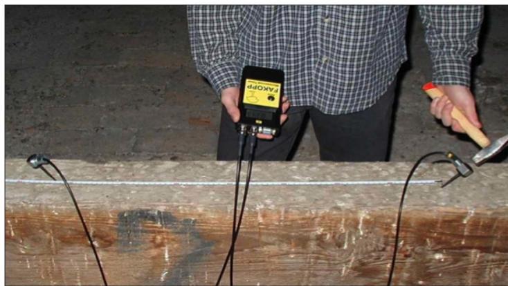
Kötőgerenda roncsolásmentes faanyagvizsgálata FAKOPP műszerrel (Divós F.)
