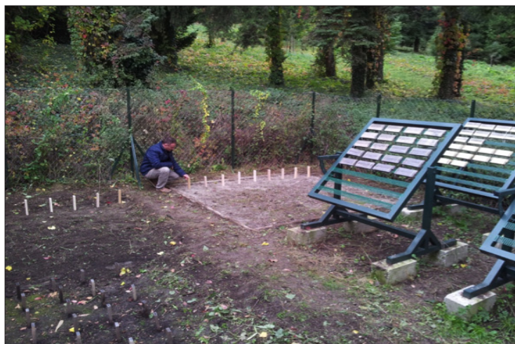
Kültéri faanyagvédelmi, tartóssági vizsgálatok Sopronban (Horváth N.)
