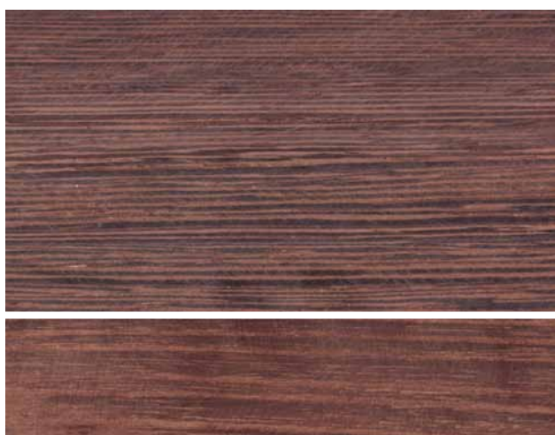
8. ábra Wenge (fent) és a 100 °C-on, 22 napig gőzölt akác színe (alul) ( \Delta E=24,1 )
