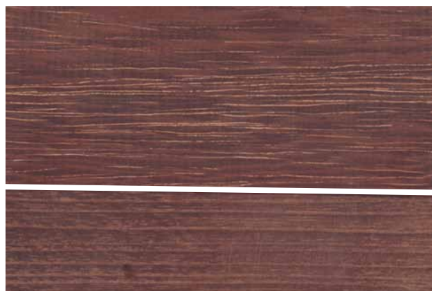
7. ábra Azobe (fent) és a 100 °C-on, 15 napig gőzölt akác színe (alul) ( \Delta E=10,6 )
