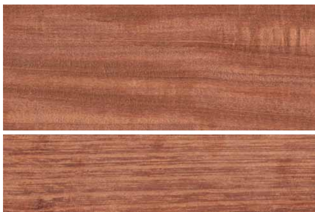
6. ábra Afromosia (fent) és a 100 °C-on, 4 napig gőzölt akác színe (alul) ( \Delta E=19,9 )
