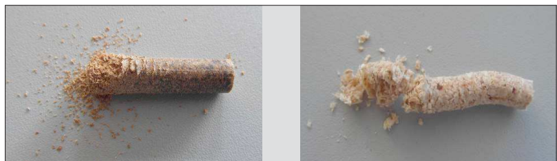
3. ábra A falsúrlódás miatti sűrűségkülönbség tölgy és fenyő mintán
